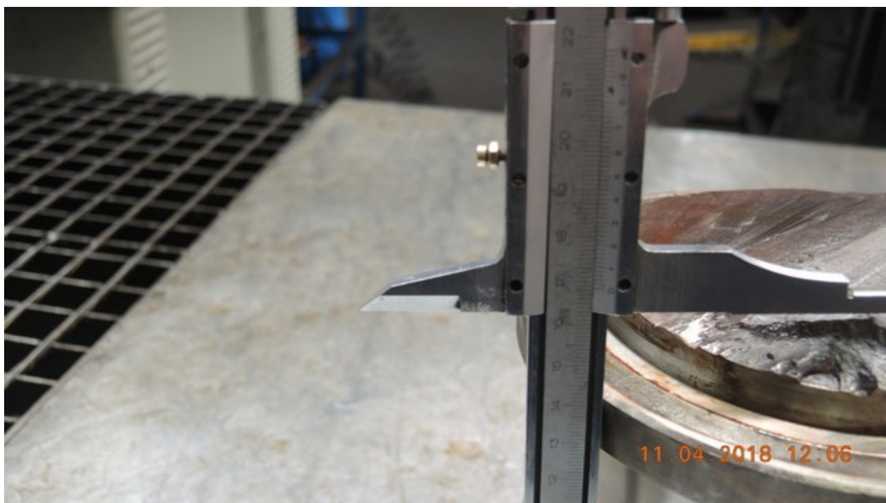
Obr. č. 12: Délka ulomeného čepu 160,85 mm
