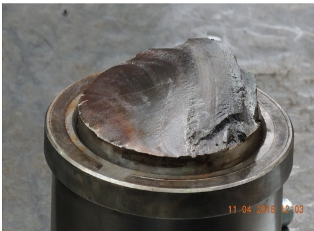
Obr. č. 8: Detail zlomeného čepu
