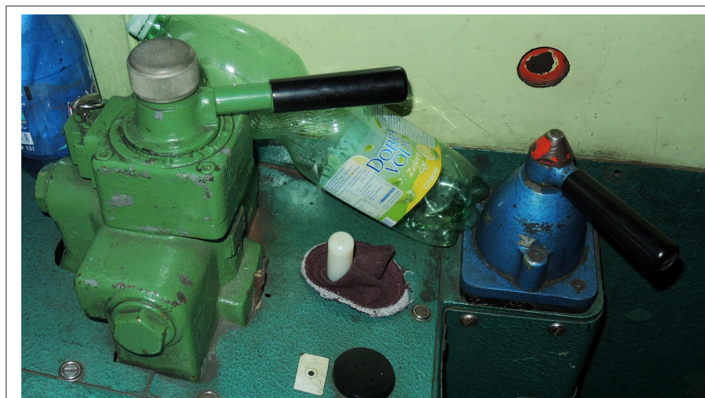
Obr. č. 14: Poloha brzdičů na stanovišti č.1 HDV
