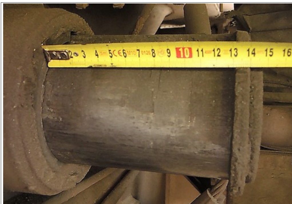
Obr. č. 15: Hodnota vysunutí pístu brzdového válce při ohledání HDV po MU, použita při ověřovacím pokusu č. 7.
