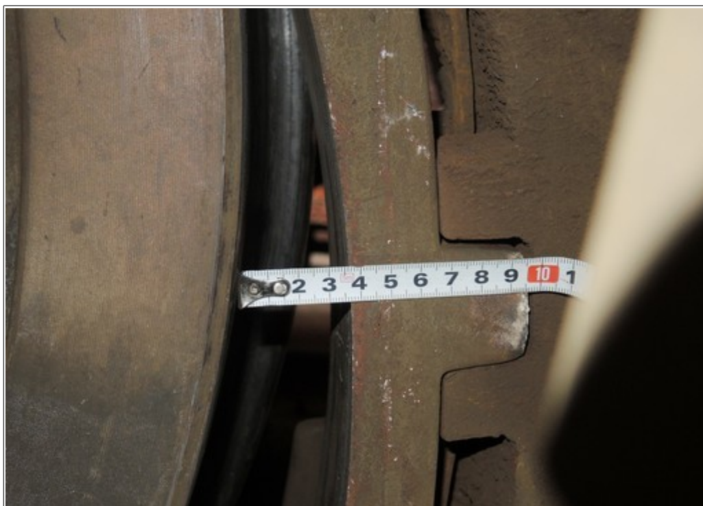
Obr. č. 16: Hodnota vůle špalíku od obruče kola při pokusu č. 7.
