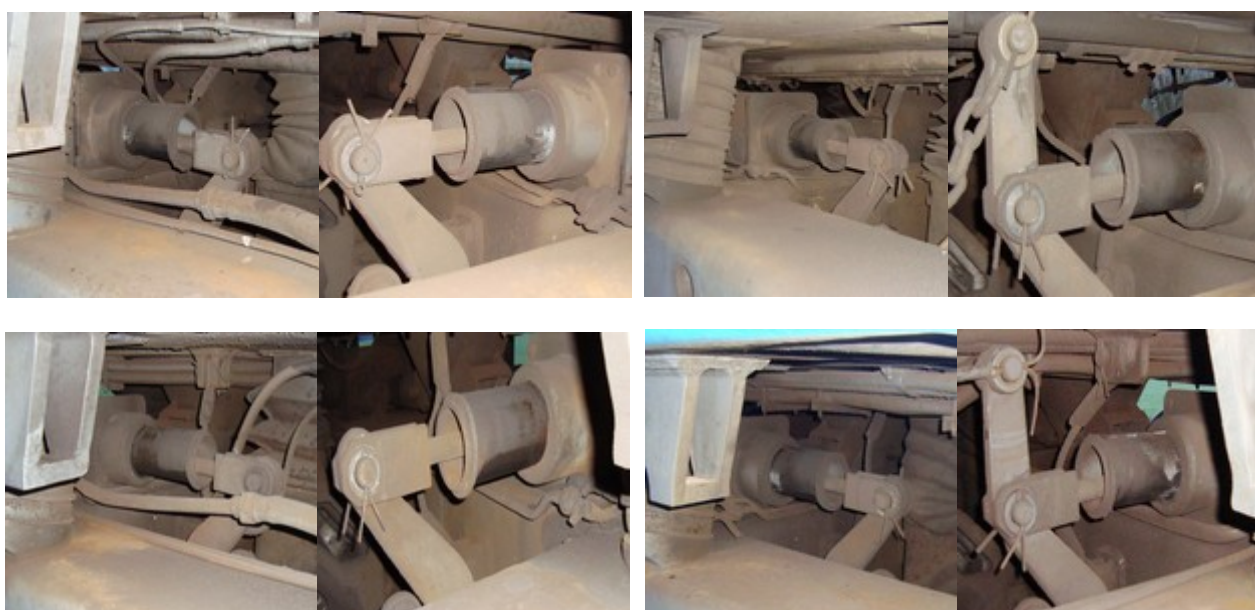
Obr. č. 17: HDV v místě zastavení na širé trati a zdokumentované vysunutí pístů všech brzdových válců poté, co strojvedoucí opětovně nedovoleně manipuloval s brzdíči a po obnovení tlaku zabrzdil.
