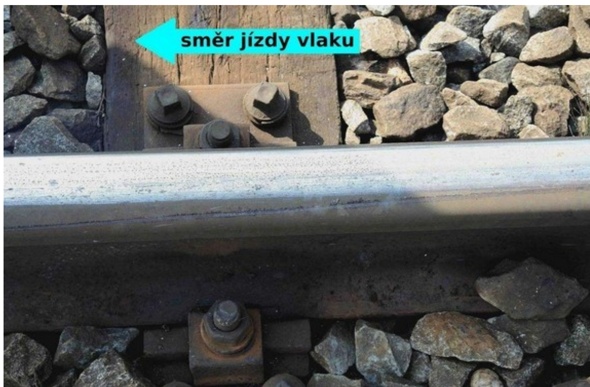
Obr. č. 5: Vryp od okolku kola na temeni levé kolejnice.
