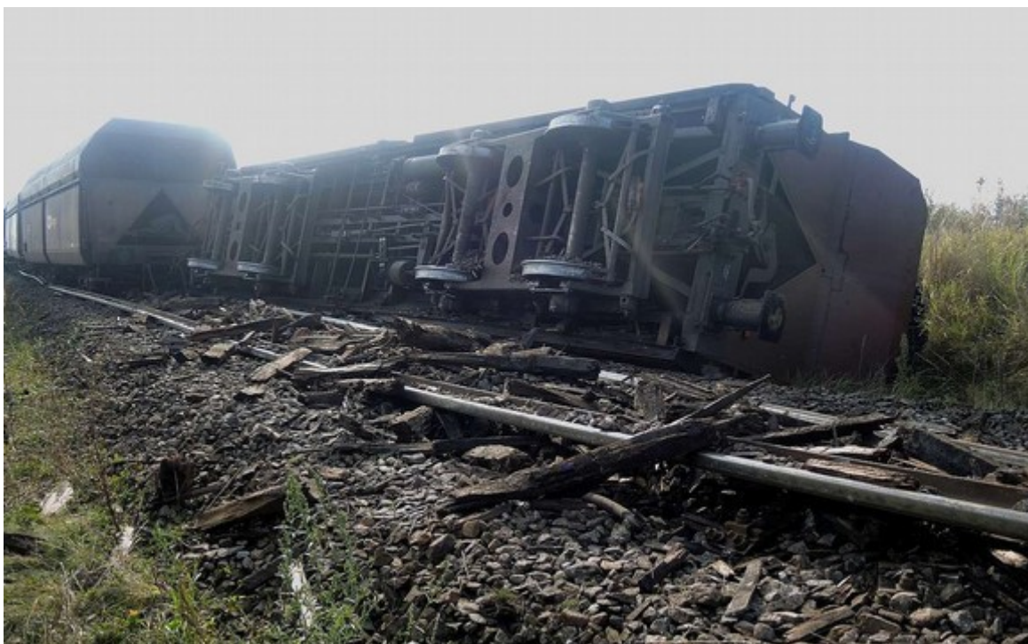
Obr. č. 6.: Převrácený vůz Falls ev. č. 31 54 6679 126-8, řazený jako 8. Značné poškození infrastruktury a drážních vozidel.
