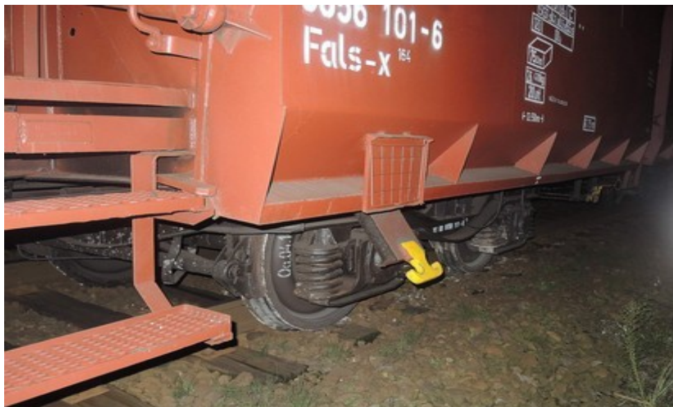
Obr. č. 3.: První vykolejený podvozek „a“ prvního vykolejeného vozu Fals-x 164 ev. č. 31 80 6656 101-6.
