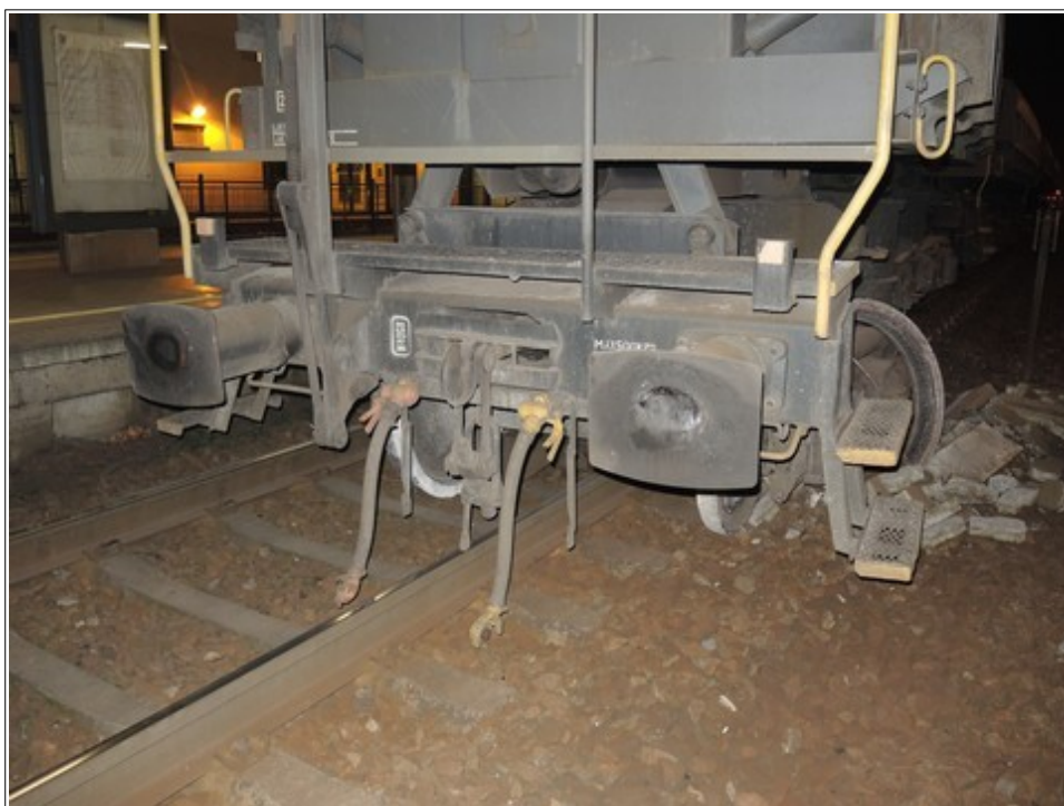
Obr. č. 1: Pohled na přední čelo vykolejeného TDV CZ-AWT 88 54 9200 105-6 v konečném postavení po vzniku MU. Zdroj: DI
