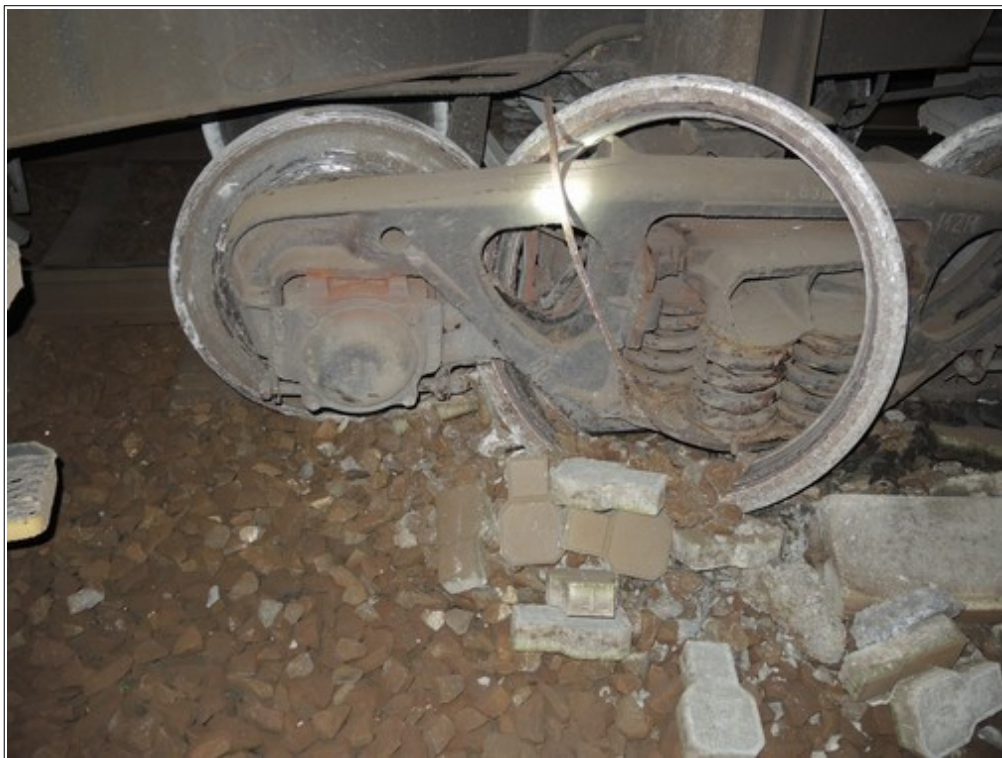
Obr. č. 6: Pohled na obruč levého kola 1. nápravy TDV 88 54 9200 105-6 navlečenou na rám podvozku.
