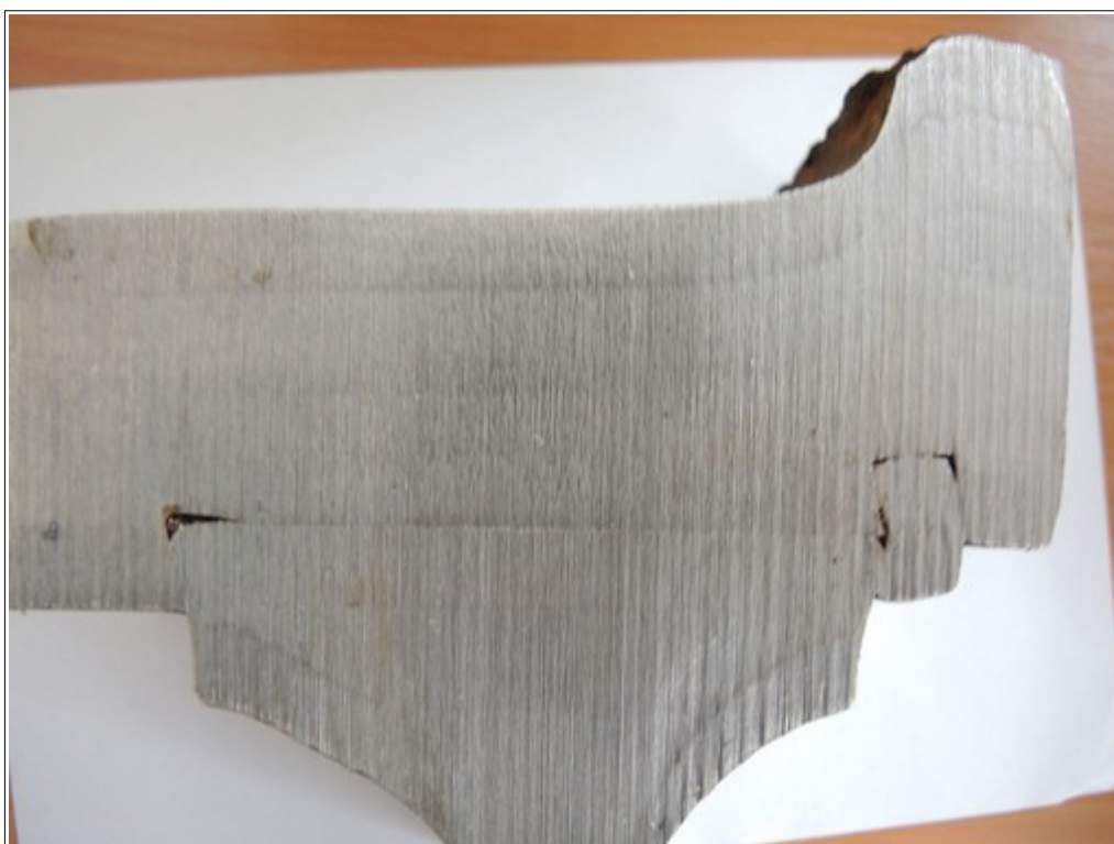
Obr. č. 8: Řez pravým obručovým kolem TDV 88 54 9200 105-6 se správným spojením obruče s kotoučem kola. Zdroj: DI
