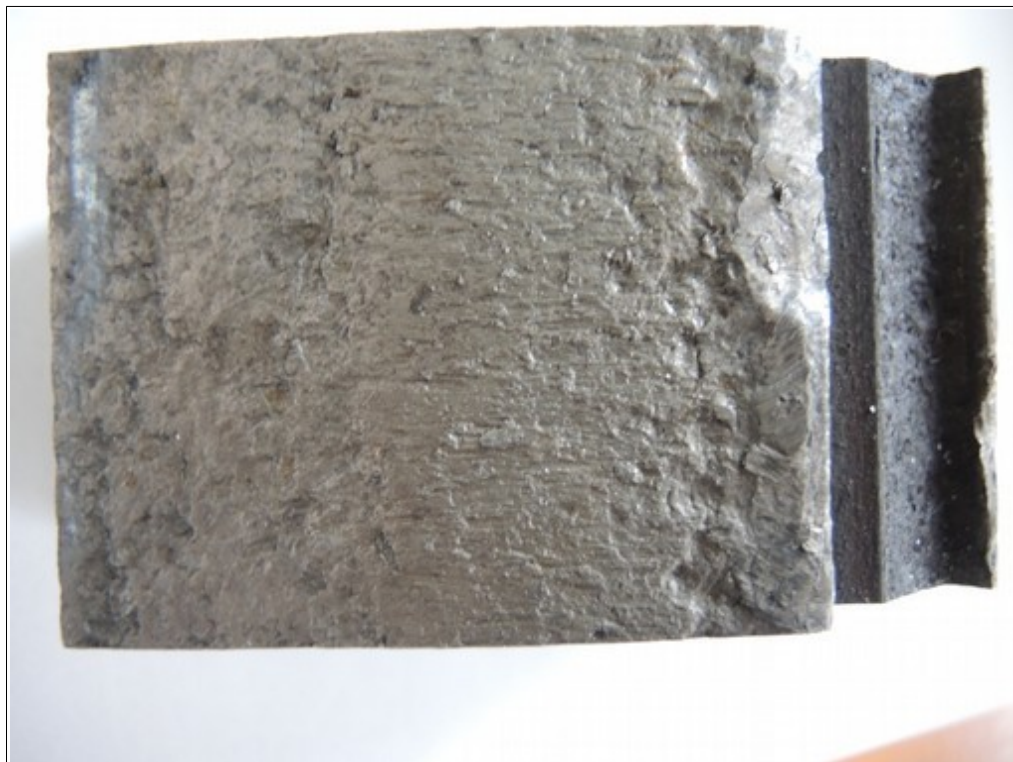
Obr. č. 9: Pohled na styčnou plochu poškozené obruče a vylomenou část obruče levého kola 1. nápravy TDV 88 54 9200 105-6. Zdroj: DI
