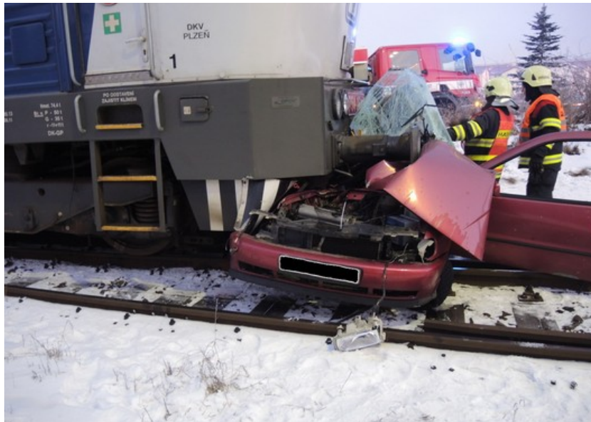
Obr. č. 6: Osobní automobil zaklíněný pod nárazníky HDV
