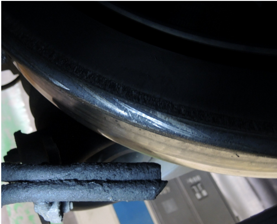
Obr. č. 6: Jeden z otěrů na kole soupravy vlaku Sv 874 Zdroj: Dražní inspekce
