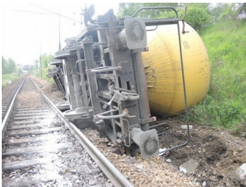
Obr. č. 1: Pohled na převrácené TDV
