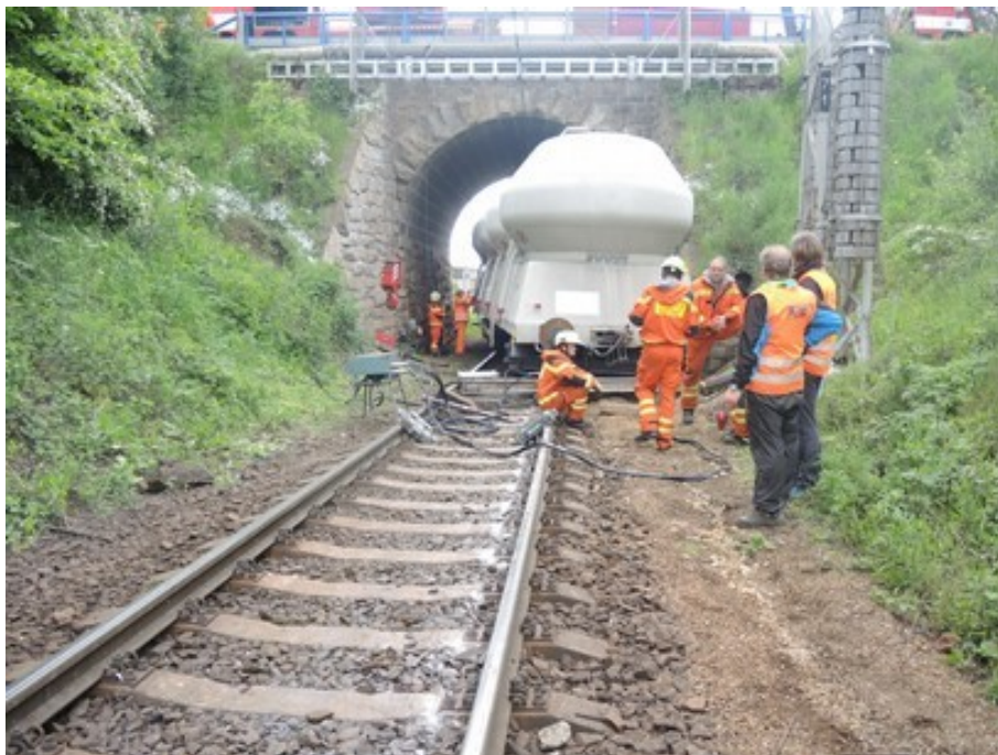
Obr. č. 12: Pohled na vykolejené předposlední TDV
