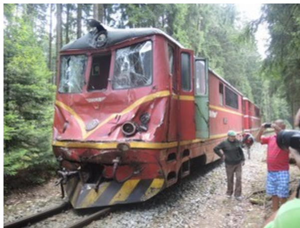
Obr. č. 5: Poškození přední části HDV č. 90 54 3 705 911-6 Zdroj:DI
