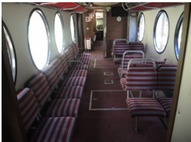
Obr. č. 8: Interiér HDV č. 90 94 3 805 901-6 po srážce. V druhé řadě sedadel vpravo se nachází sedadlo, u něhož došlo při srážce k utržení opěradla Zdroj: DI
