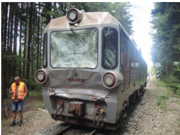
Obr. č. 4: Poškození přední části HDV č. 90 54 3 805 901-6 Zdroj:DI
