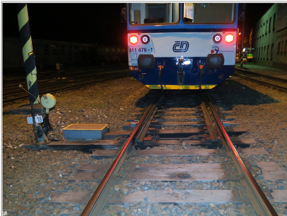
Obr. č. 6: Pohled na zadní čelo vykolejeného vlaku Os 23121 – snímek také jednoznačně dokládá polohu obou odlehlých jazyků výhybky č. 18.
