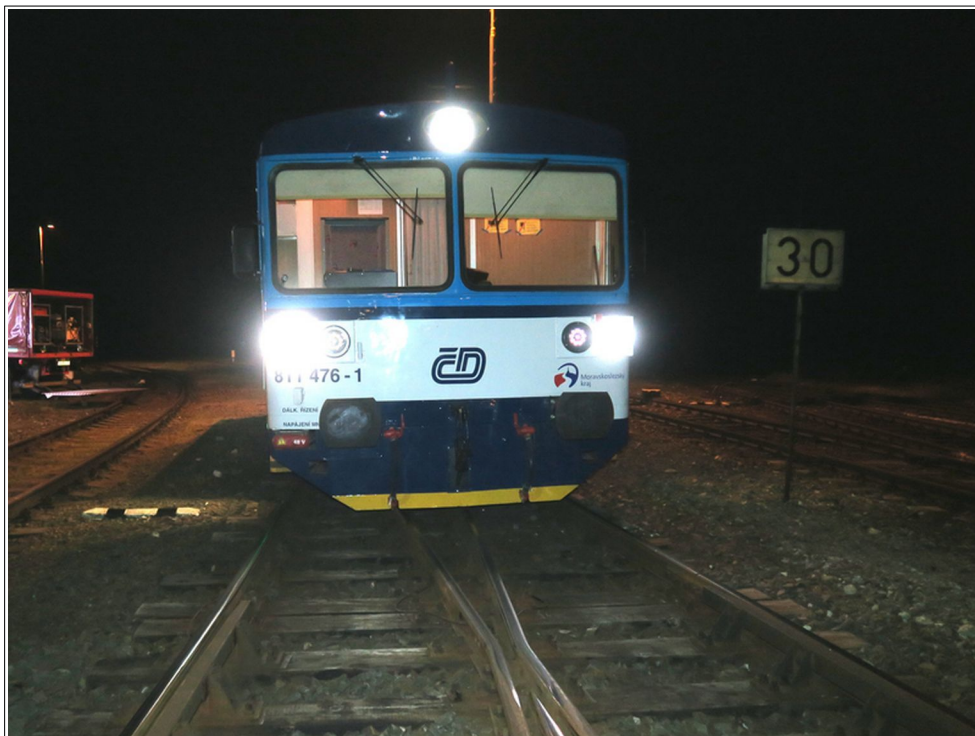
Obr. č. 5: Pohled na přední čelo vykolejeného vlaku Os 23121 stojícího v konečném postavení po MU na výhybce č. 18.
