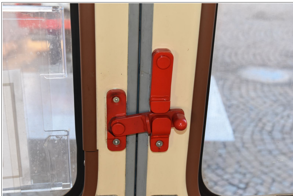
Obr. č. 8: Ukázka nové zajišťovací závory vnějších dveří služebního oddílu (na HDV 854.225-0)
