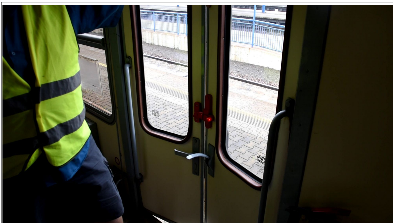
Obr. č. 9: Maximální možné pootevření dveří se zavřenou novou zajišťovací závorou
