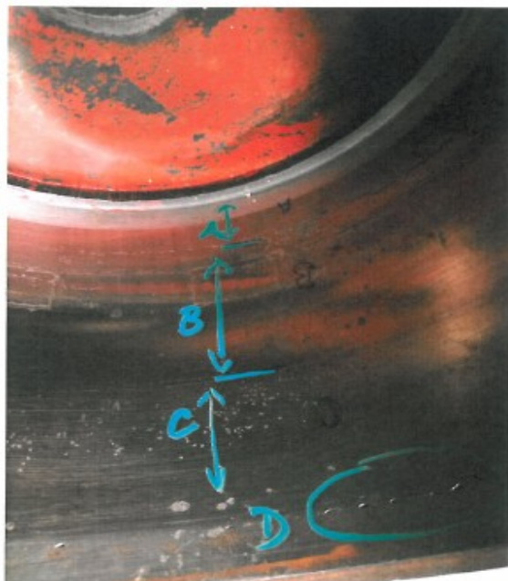
Obr. P2 – Detail vnitřní plochy válce s vyznačenými oblastmi vzorků k odběru pro další analýzy
