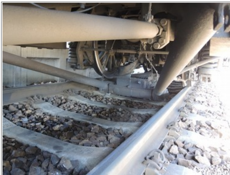
Obr. č. 3: Utržené zařízení přenosu tažných sil Zdroj: DI
