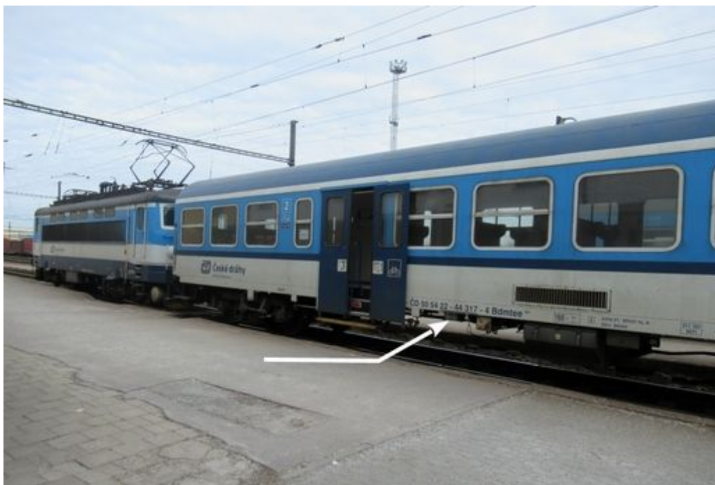
Obr. č. 6: Stav clonek (zelené) signalizují stav odbrzděno na DV řazeném v posunovém dílu Zdroj: PČR
