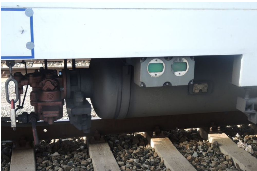
Obr. č. 4: Ukázka umístění clonek brzd (stav odbrzděno)
