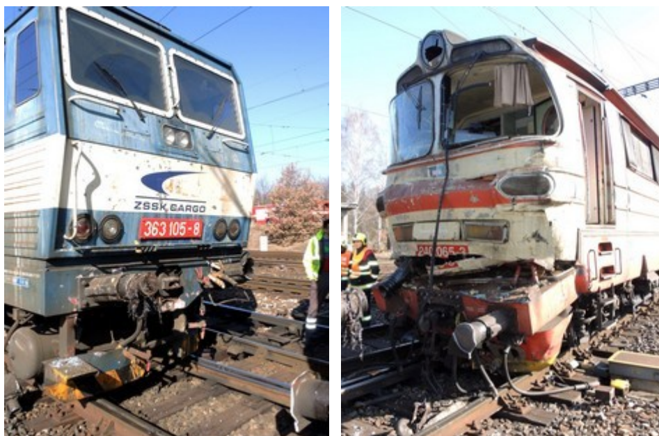
Obr. č. 1: Pohled na poškozená čela HDV
