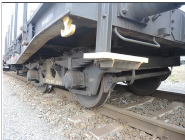
Obr. č. 7: Vykolejený zadní podvozek „b“
