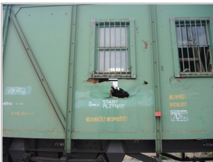
Obr. č. 3: Poškození DV
