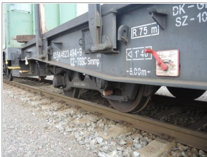
Obr. č. 4: Vykolejená 1. náprava předního podvozku Zdroj: DI
