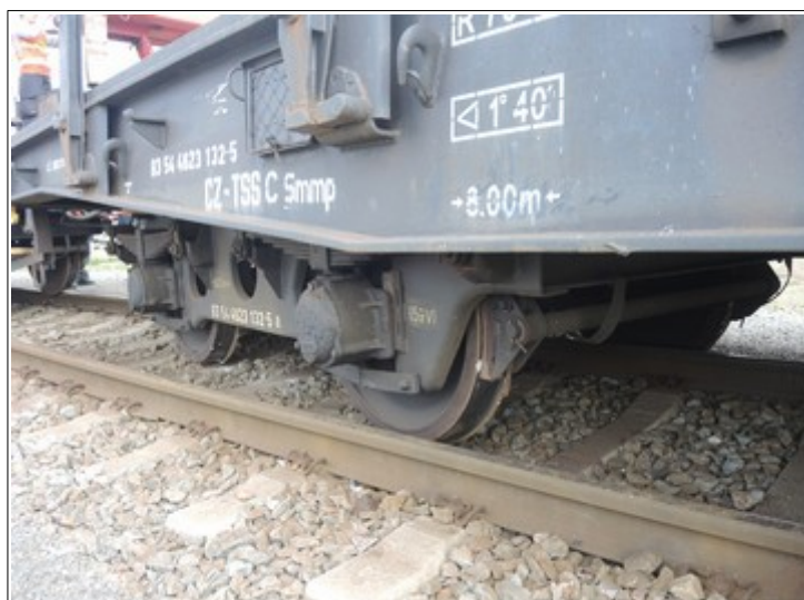
Obr. č. 6: Vykolejený přední podvozek „a“
