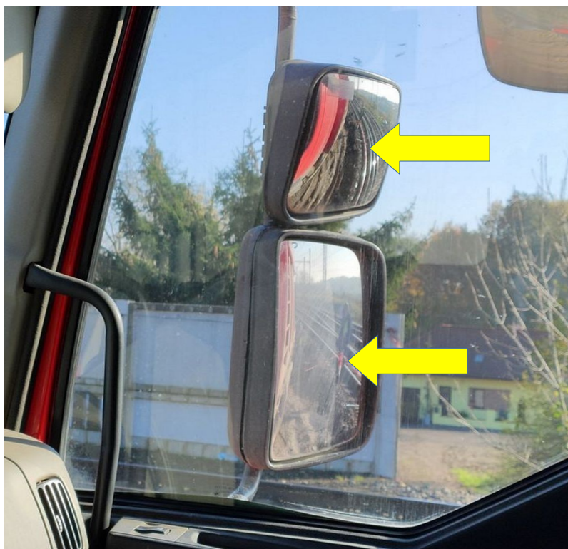
Obr. č. 9: Detail pohledu do zpětného zrcátka (poloha po MU) s patrnou červenobílou páskou, viz šipky
