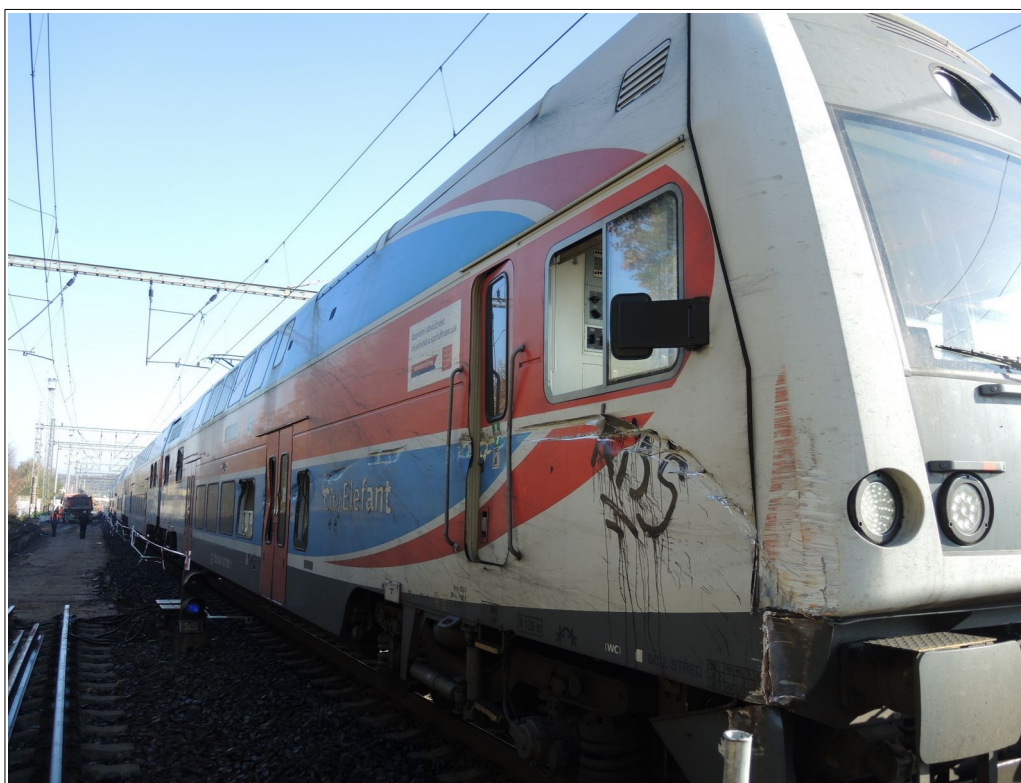
Obr. č. 2: Pohled na poškození vlaku Os 9318
