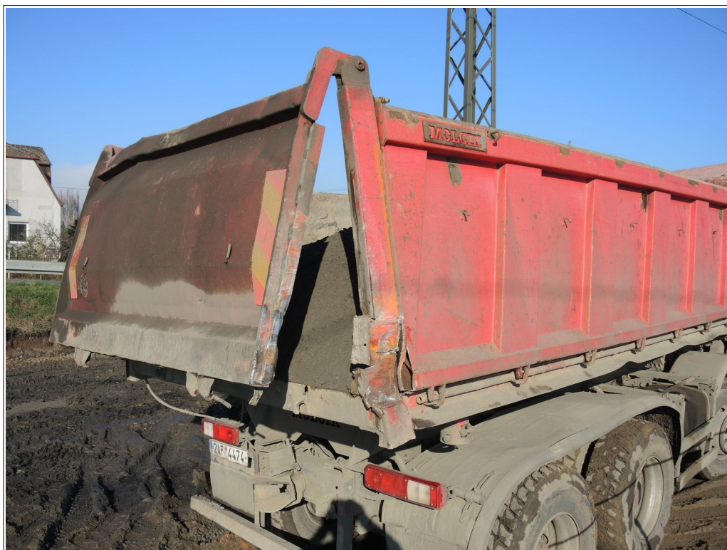
Obr. č. 5: Deformace zadní části pravé bočnice a zadního výklopného čela korby NA Zdroj: DI
