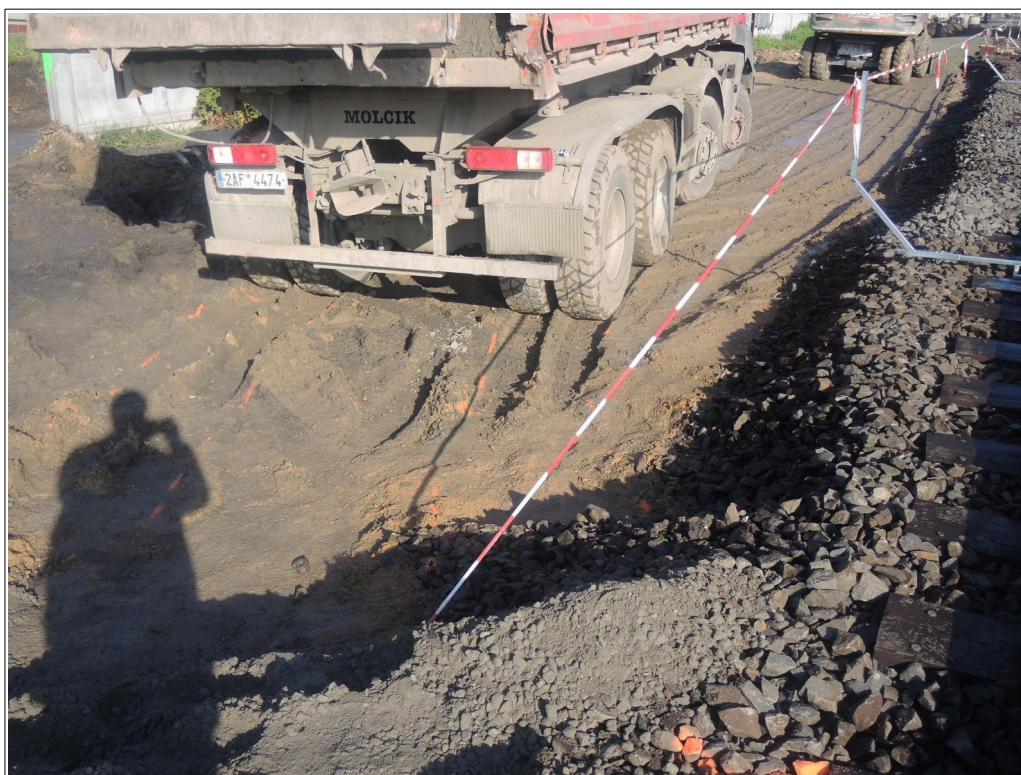
Obr. č. 4: Oranžově vyznačeny stopy jízdy NA po srážce, hromada substrátu vysypaná následkem srážky na výstražnou pásku Zdroj: DI
