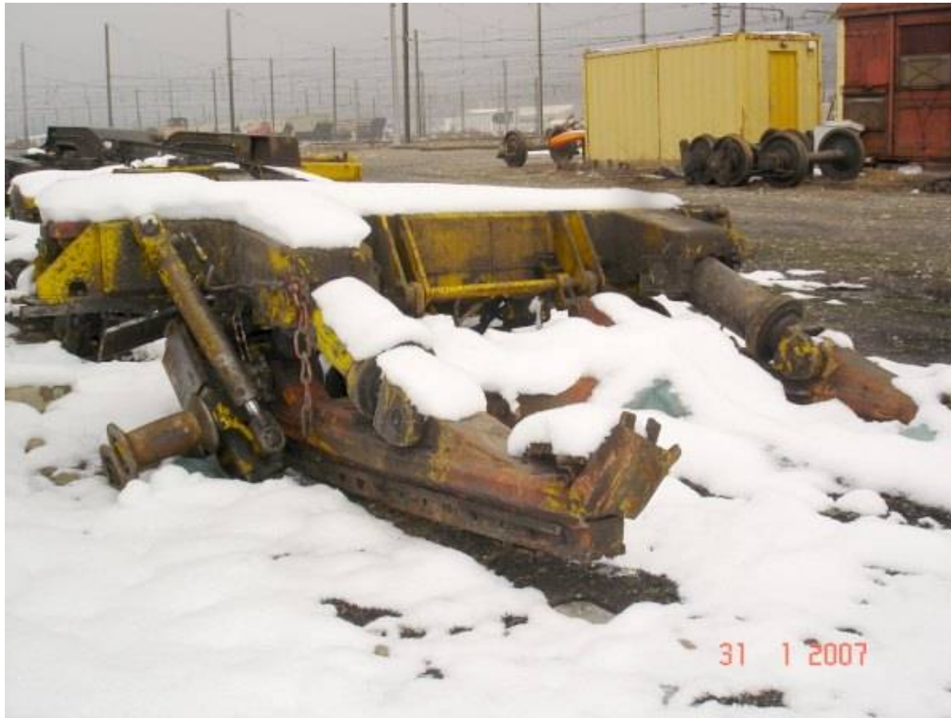
Traineau chenille qui se positionne sous le wagon WM en position travail
