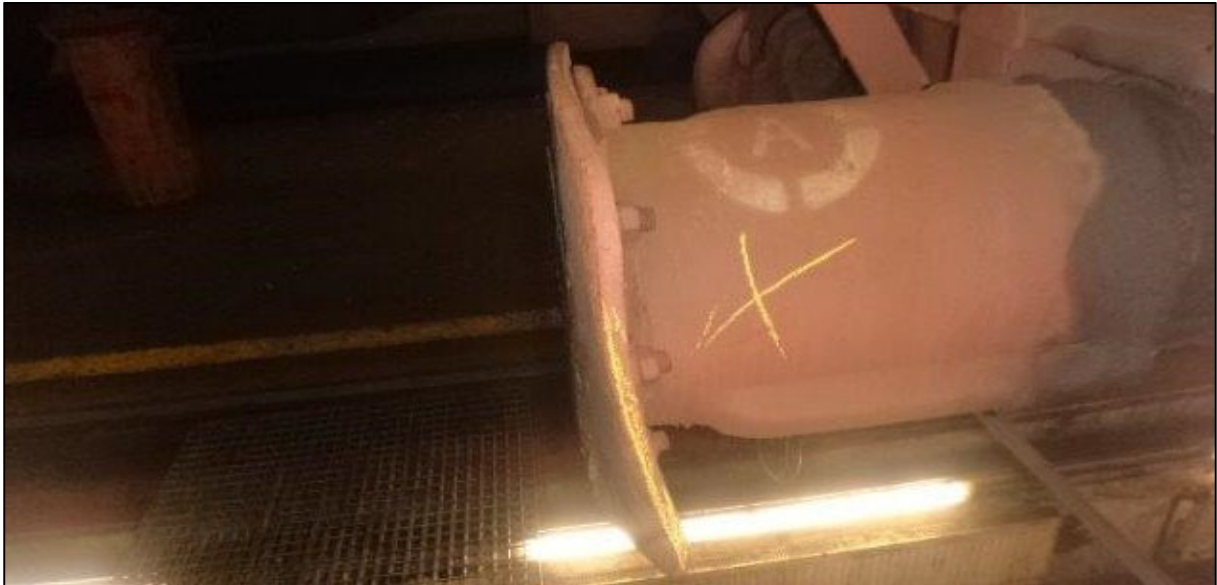
Abbildung 12: Verformter Pufferteller am Wagen 23 54 4366 259-0 9
