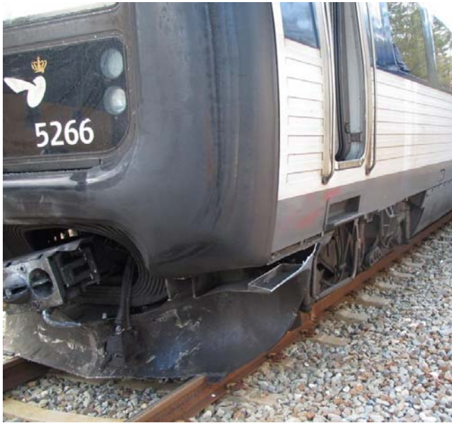
4 Nogle af skaderne på togsættets front
