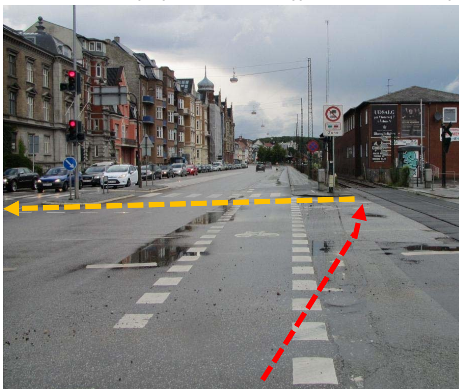
Venstresvingende cyklisters sandsynlige rute langs overkørslen - set mod nord.
