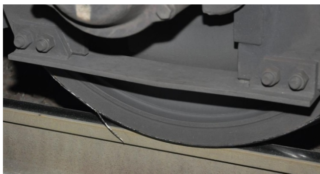
Foto 3 Hjul med spån efter passage af sporskiftet
