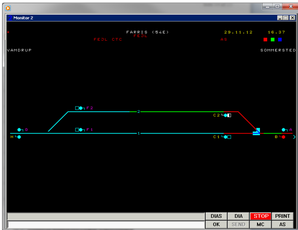
Foto 9 RFC Fredericia - HG 45685 har forladt Farris. sporskifte 1010 er ude af kontrol og udkørselstogvejen er ikke opløst
