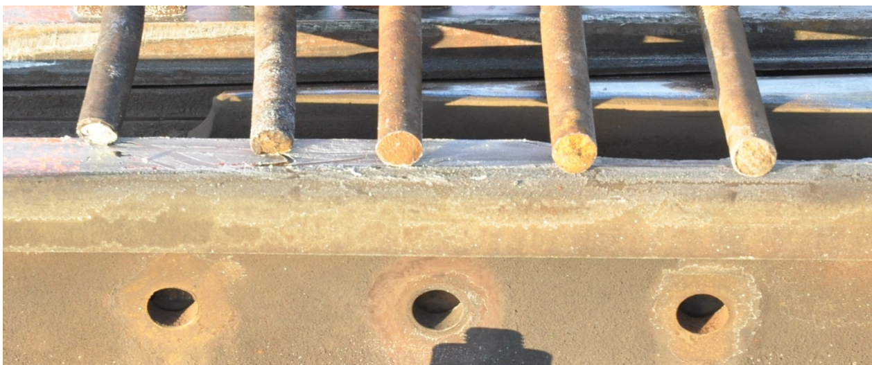
Foto 8 De fem bolte 1-2-3-5 og 6 (ikke rækkefølgen på foto) fundet omkring hjertespidens og mellemklodsens. Boltene til venstre er den eneste, der morgenen efter afsporingen (da foto blev taget) fremstår med friskt brud. Under boltene til højre anes afskalningen på vingeskindens skinnehoved.
