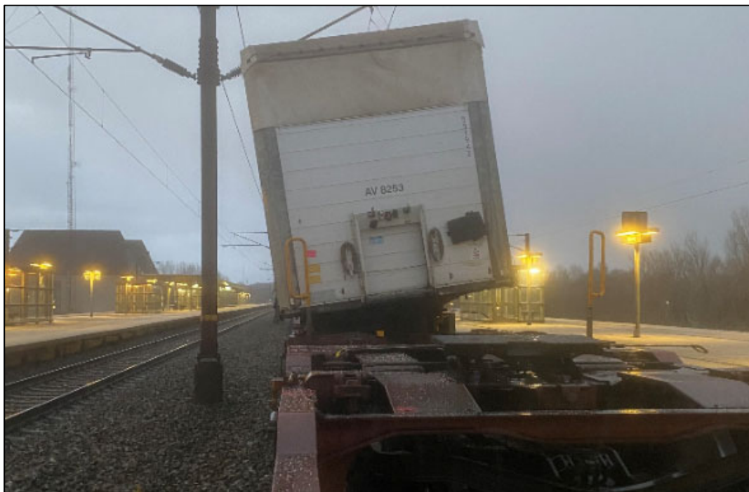
Foto 1: Sættevognstrailerens position på vogn efter ankomst til Nyborg.
