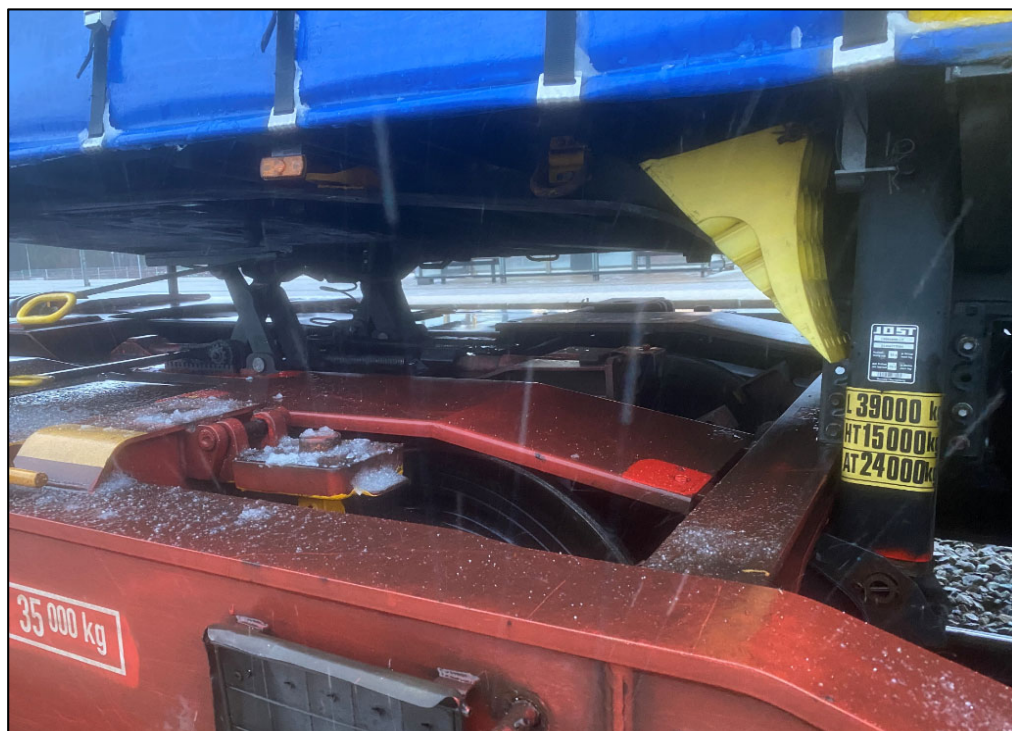
Foto 5: Sættevognstrailerens støtteben forhindrede sættevognstraileren i at bevæge sig længere bagud.
