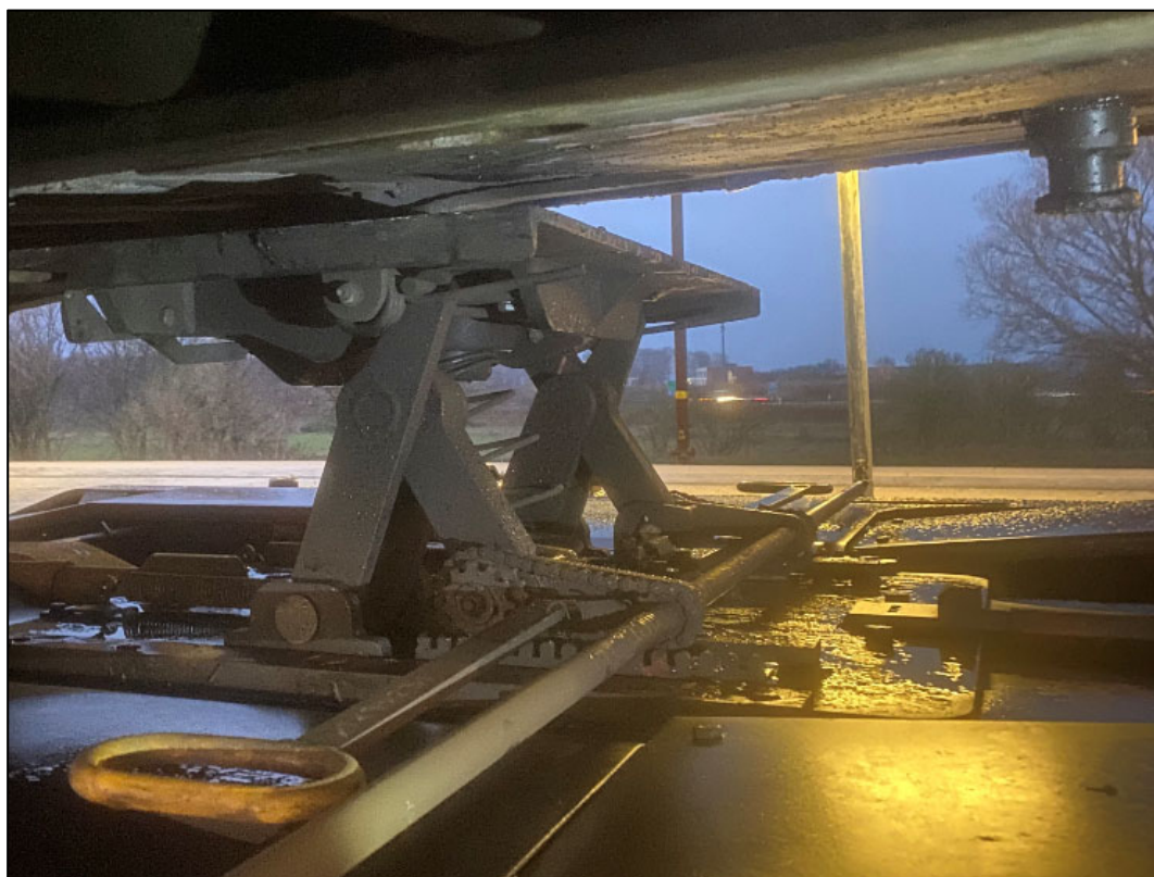
Foto 2: Hovedboltens placering bag ved skamlen efter ankomst til Nyborg.
