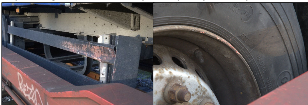
Foto 7: Cyklistværn ses bøjet og påført maling fra vognens kant. Mærker på dæk og maling på fælg.
