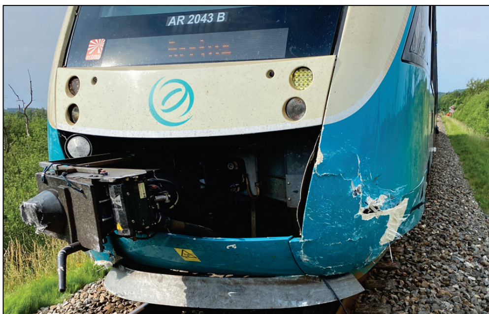
Foto 10. Skader på togets front efter kollisionen. Foto Arriva.
