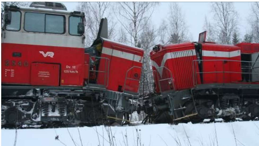
Kuva 21. Molemmat veturit vaurioituivat pahoin törmäyksessä.
