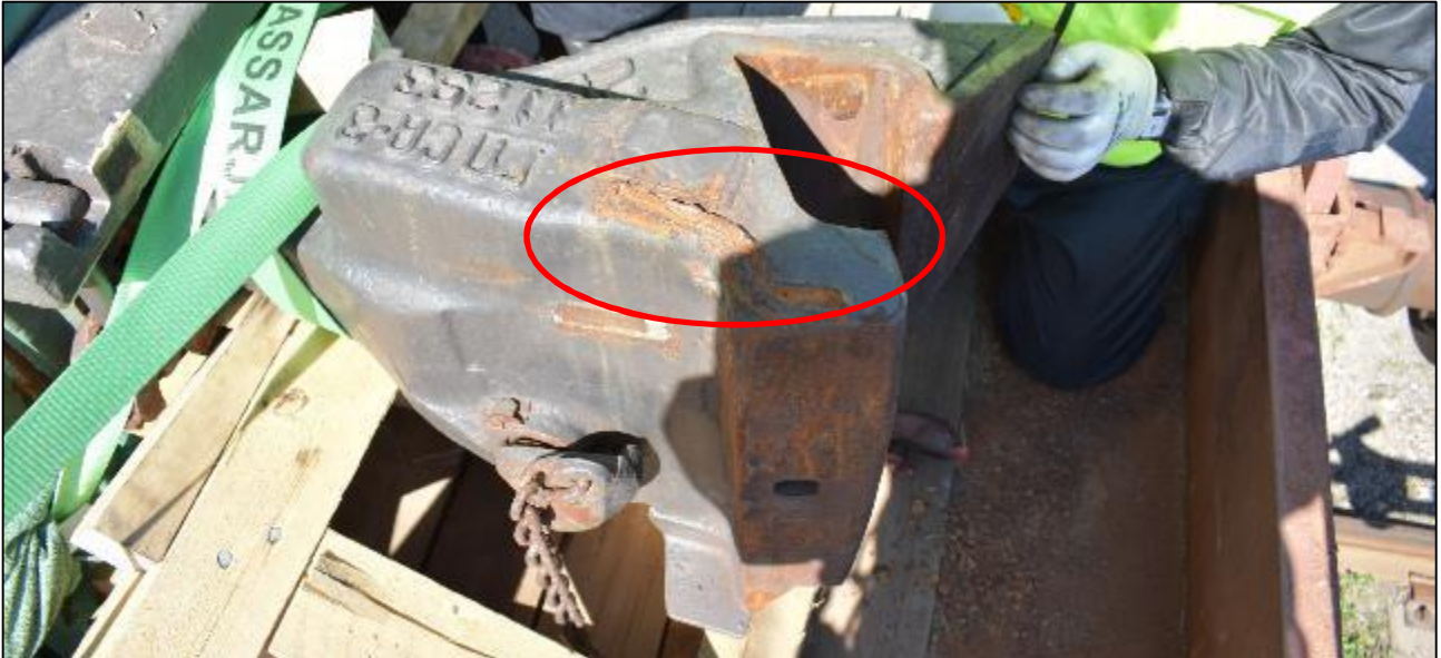
Kuva 14. Ensimmäisen vaunun takapään keskuspuskin, josta ylempi ylisyoöksynestin on repeytynyt irti. (Kuva: OTKES)
