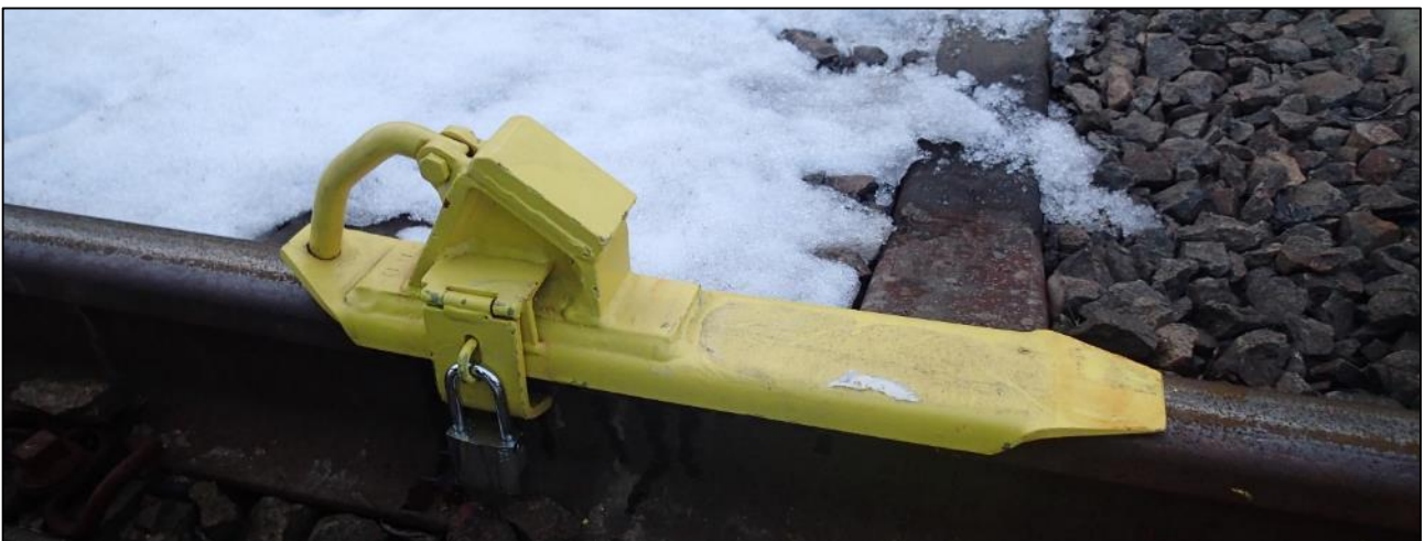
Kuva 10. Lukittava pysäytyskenkä itäisellä kiskolla vaunuston eteläpään alkuperäisellä seisontapaikalla. Salpa, joka estää kengän nostamisen kiskolta, on lukittu paikalleen riippulukolla. (Kuva: OTKES)
