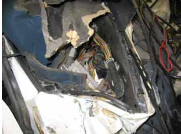
Moottorin testausta varten korjattu johtosarja
