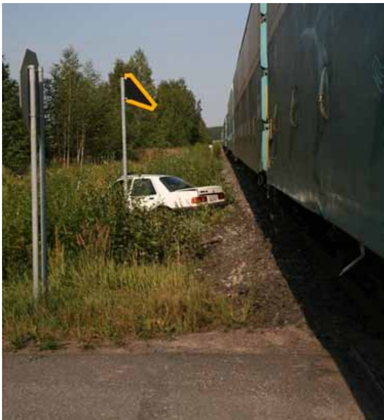
Kuva 2. Juna ja auto törmäyksen jälkeen. Auto paiskautui tulosuuntansa puolelle rataa 18 metrin päähän törmäyskohdasta ja veturi pysähtyi 276 metrin päähän törmäyskohdasta.
