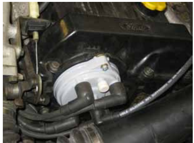
Moottorin testausta varten uusittu virranjakajan kansi
