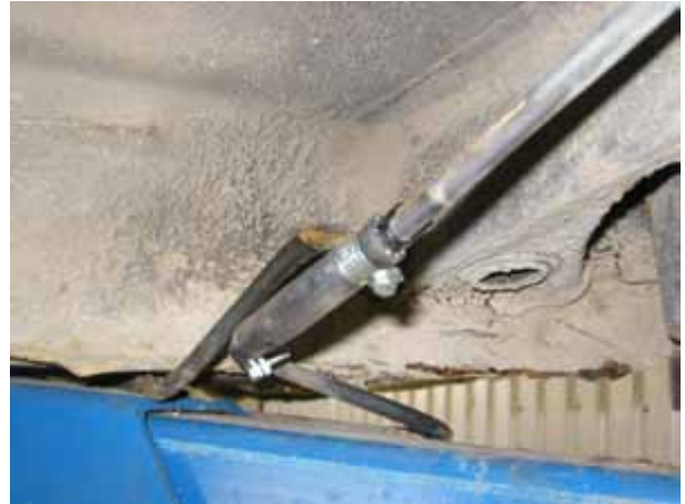
Polttoaineputken liitos (tehty paikallisella korjaamolla onnettomuuden jälkeen)
