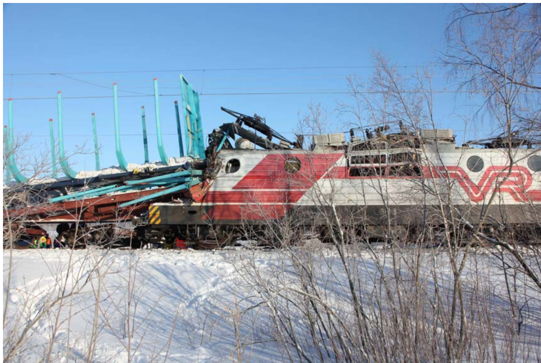
Kuva 2. Avustettavan junan viimeinen vaunu työntyi veturin sisään ja toiseksi viimeinen vaunu nousi viimeisen vaunun päälle. (Kuva: Poliisin tekniikka)
