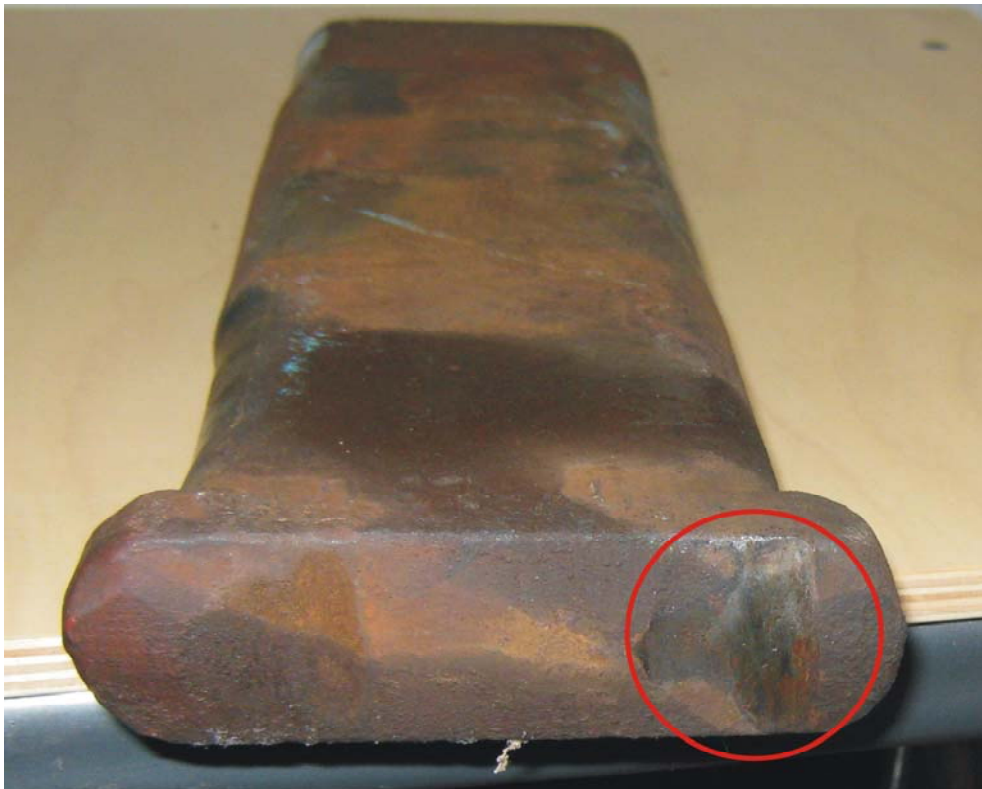
Kuva 5. Vetokiilassa olevasta kulumasta näkyy, että kiila on ollut pitkään vain yhden ruuvin kannattelemana (merkitty punaisella ympyrällä).
