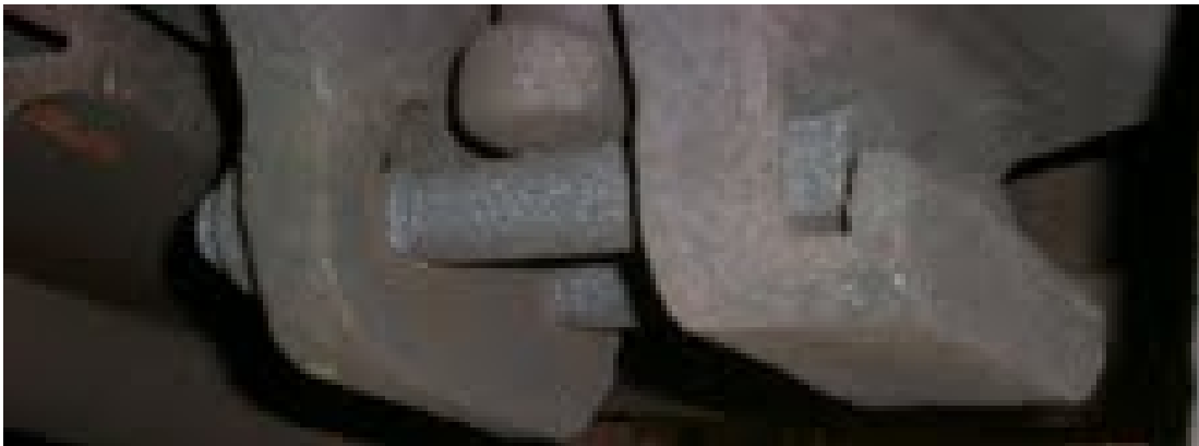
Kuva 6. Hyllyllä varustettu SA3-kytkimen vetosanka.
