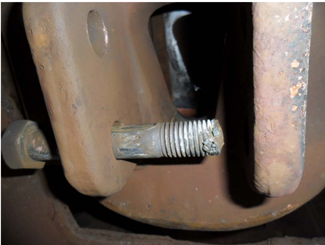
Kuva 3. Vetosanka, josta puuttuu toinen kuusioruuvi. Jäljellä olevan ruuvin päässä näkyy jälkiä hitsauksesta.
