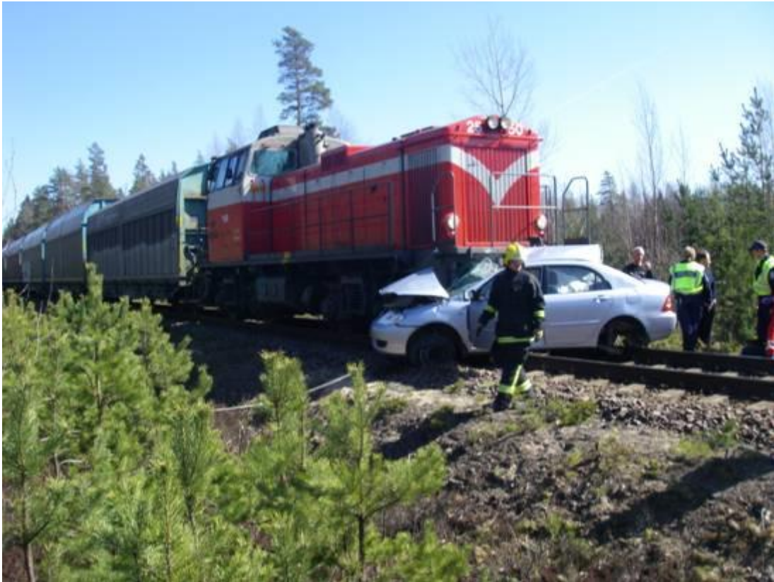
Kuva 2. Auto raahautui tavarajunan edessä 495 metrin päähän onnettomuustasoristeyksestä. Juna pysyi kiskoilla.
