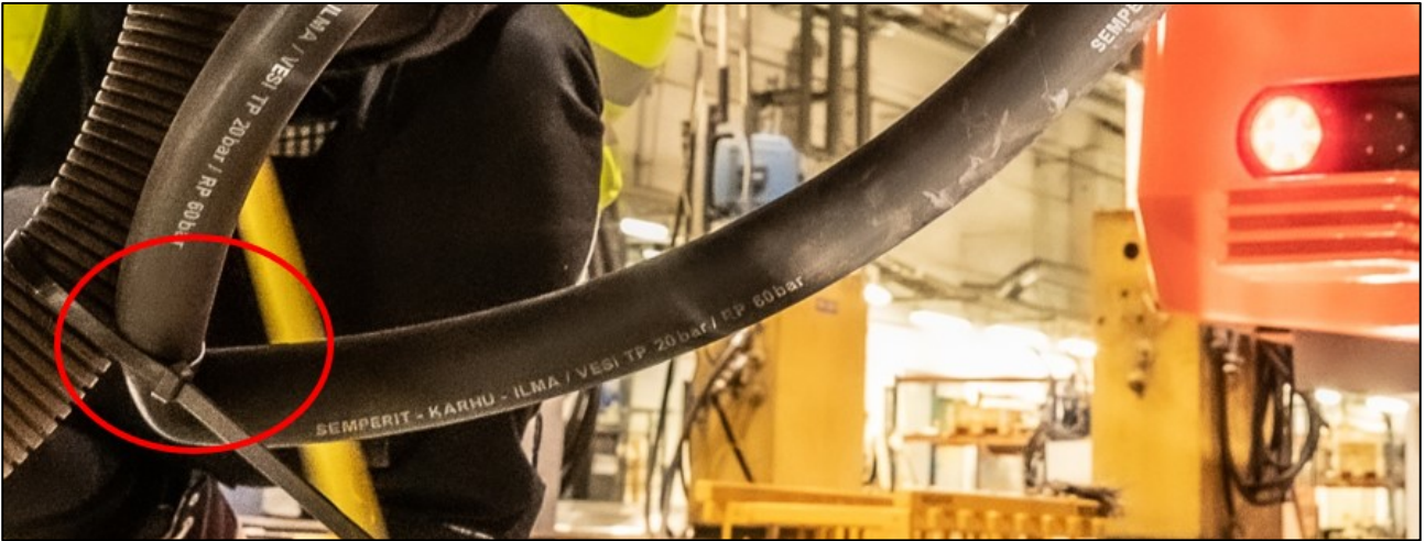
Kuva 14. Jarrujohtona käytetyn letkun litistyminen nippusiteen kohdalla. Kuvassa onnettomuuden jälkeinen asennus varikolle siirtoa varten. (Kuva: OTKES)
