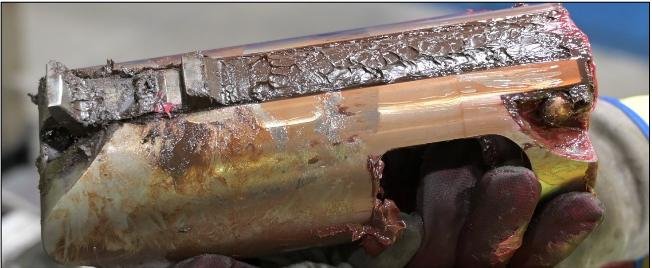
Kuva 10. Metrojunan päätykytkimen s/n M123 purun yhteydessä todettu salpojen voitelu ja korroosiotilanne. (Kuva: OTKES)
