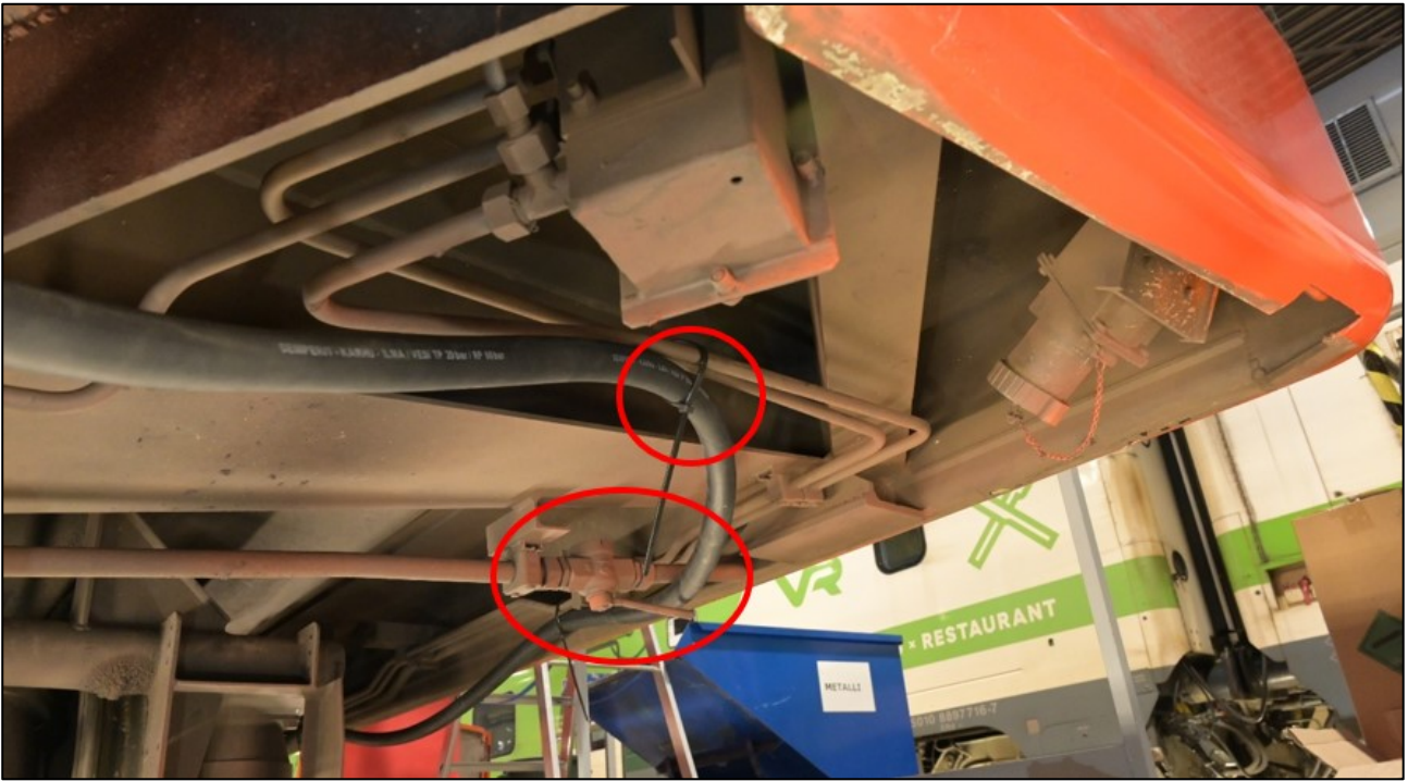
Kuva 16. Metrovaunun alle sidotun jarrujohdon letkun reitillä on laitteita, joihin se voi letkun päästä vedettäessä litistyä niin, että ilman virtaus letkussa hidastuu. (Kuva: OTKES)
