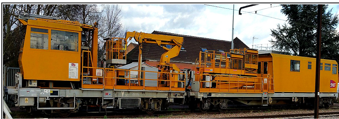
Fig. 10 : L'engin de maintenance des caténaires de type EMC 320
