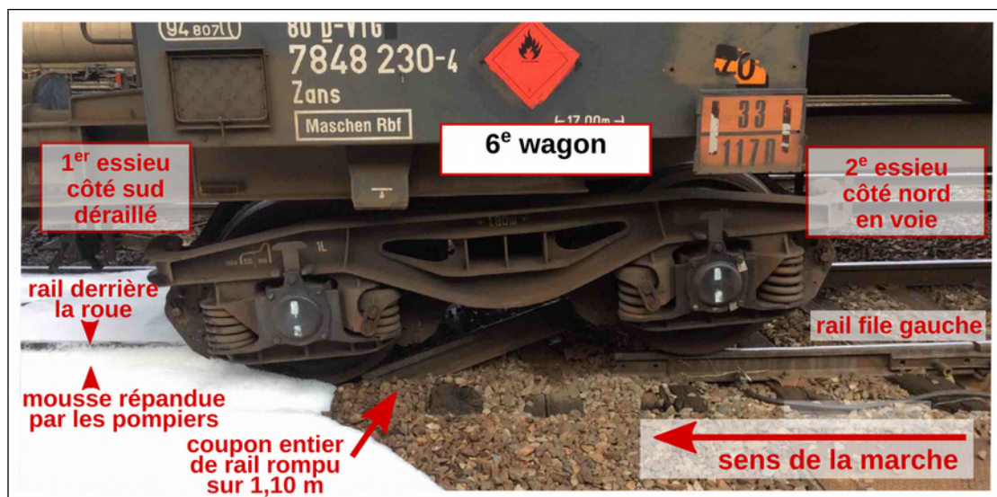
Figure 15 : le bogie avant du 6 e wagon
