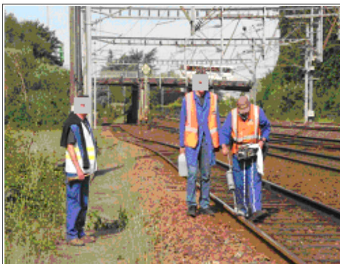
Figure 12 : contrôle continu aux ultrasons à pied d'œuvre par canne
