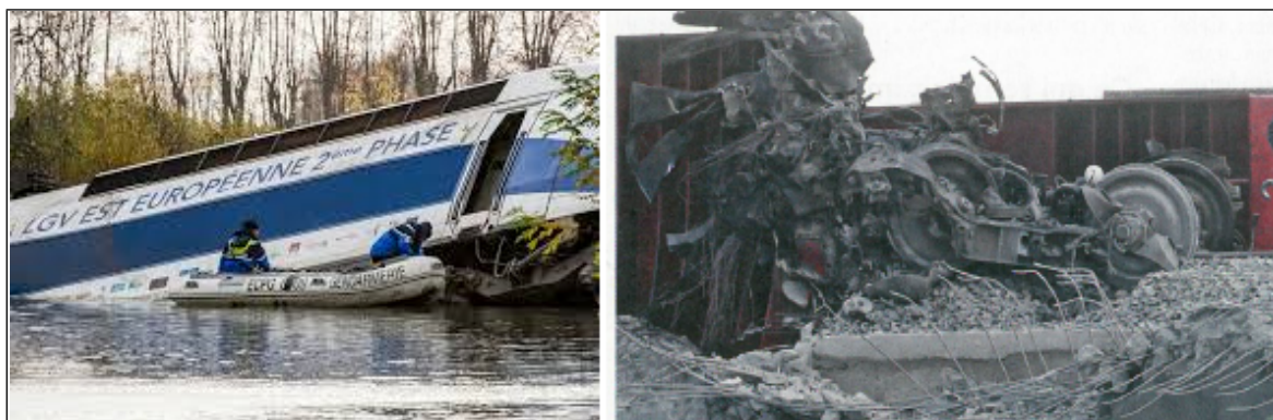
Figure 2 : Vues de la motrice arrière dans le canal et du bogie arrière de la motrice de tête encastré dans la poutre latérale du pont-rail
