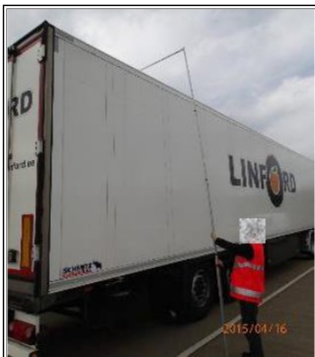
Figure 22 : Mesure physique de la hauteur au bureau d'information Fret
