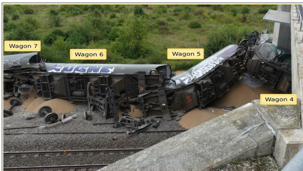
Figure 22 : vue des wagons 4 et 5 « accrochés » sur l'angle du mur en retour du pont-rail (Source BEA-TT)
