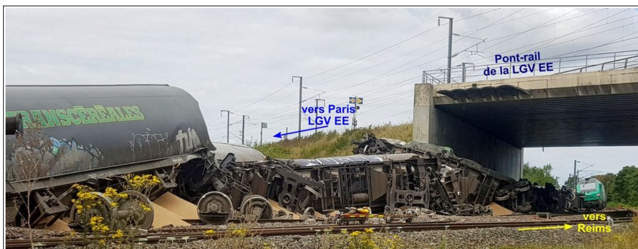
Figure 2 : train accidenté – wagons déraillés de 9 à 1
