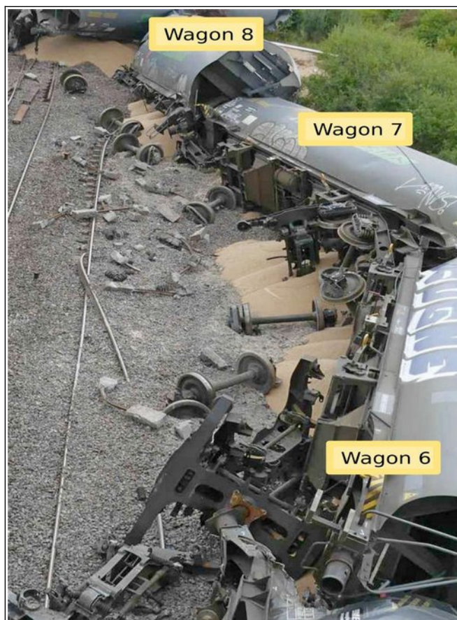
Figure 33 : vue générale depuis le pont-rail rail droit sur les blochets de traverses – rail gauche rompu
