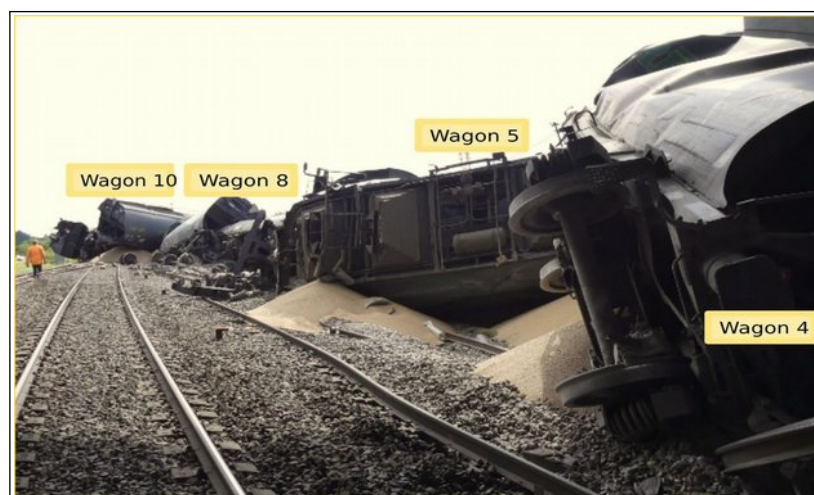
Figure 23 : vue des wagons 4 à 10 déraillés, renversés en alignement
