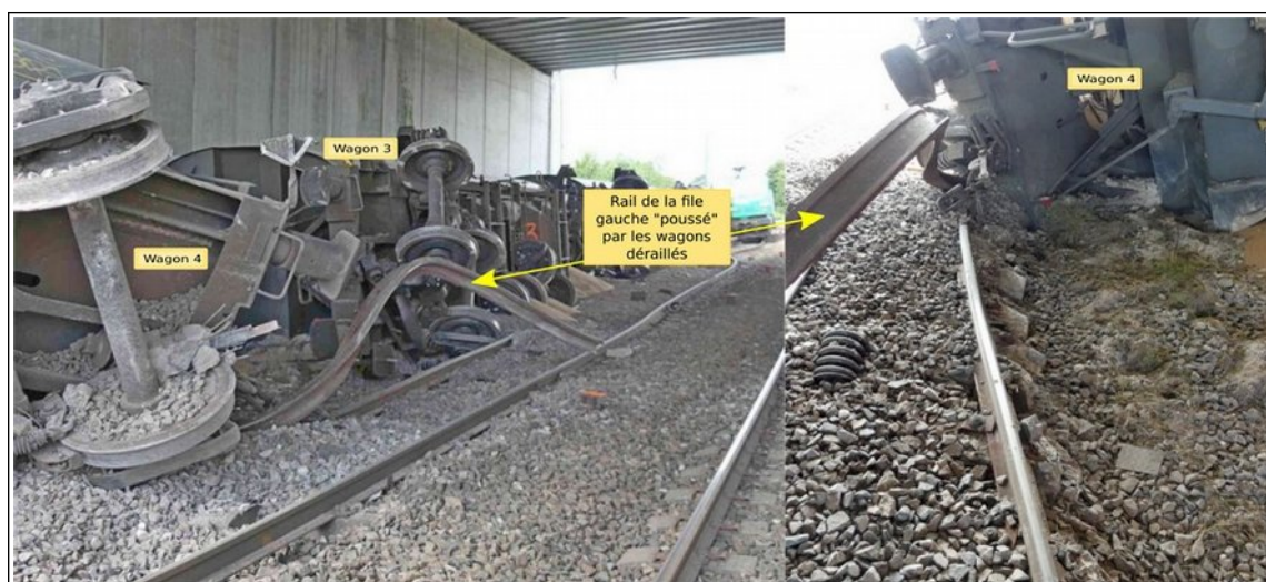
Figure 34 : vue générale depuis le pont-rail rail gauche poussé et libéré des blochets des traverses
