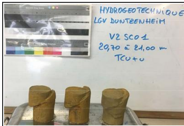
Figure 43 : échantillons d'argiles après rupture lors de l'essai triaxial
