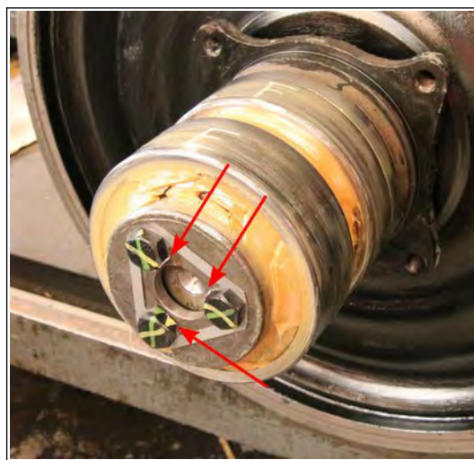
Figure 14 - exemple de chapeau de fusée avec tôle et ergots métalliques repliés (photo BEA-TT) (nota : les roulements et la boîte représentés ne sont pas du design qui équipe le wagon accidenté)
