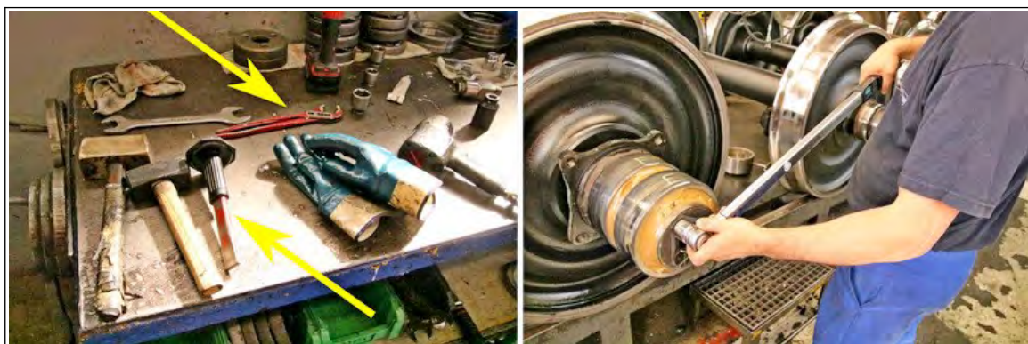
Figure 44 - outils de serrage des vis et des tôles frein du chapeau (photo BEA-TT)
