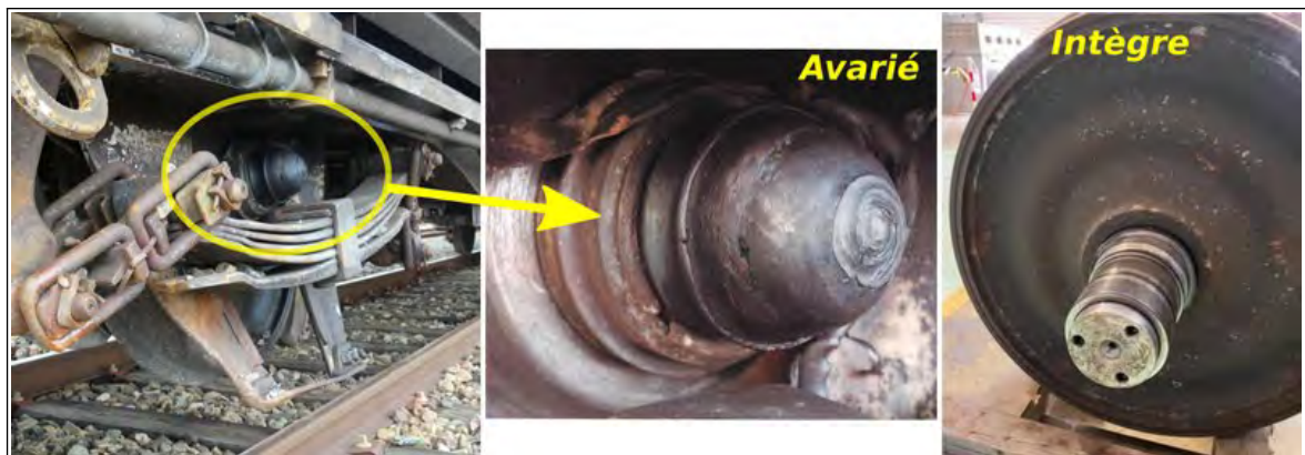
Figure 20 - fusée rompue (vues gauches) et fusée intègre (vue droite) (photos BEA-TT)
