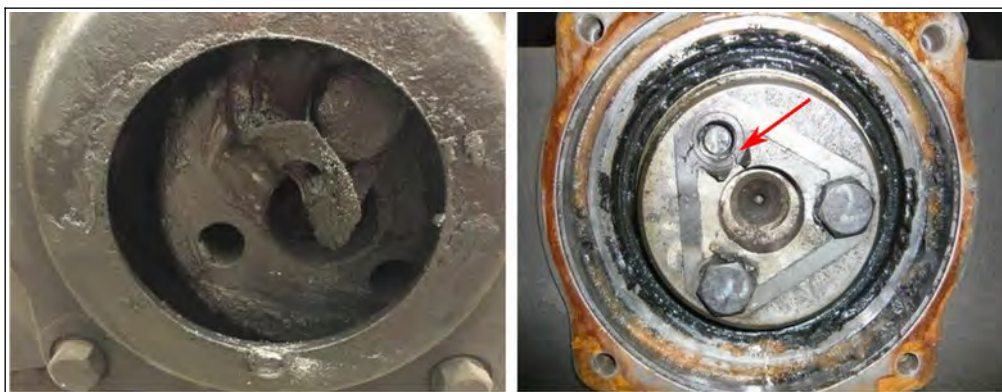
Figure 39 - boîte trépanée, tôle frein-de-vis, et vis manquante (source Valdunes)
