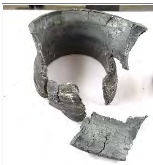
Figure 26 - bague intérieure du roulement retrouvée en voie (dossier judiciaire)
