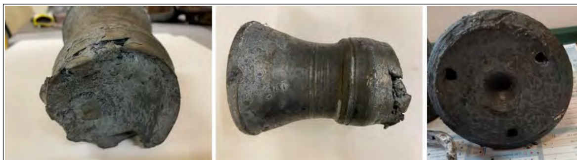
Figure 25 - extrémité de la fusée retrouvée en voie (dossier judiciaire)
