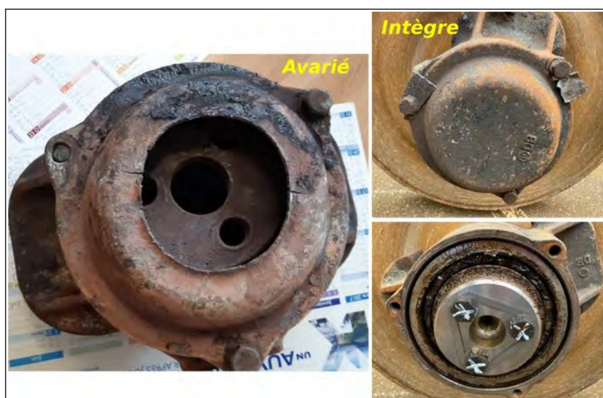
Figure 24 - boîte retrouvée et la boîte intégrée avec et sans couvercle (dossier judiciaire)
