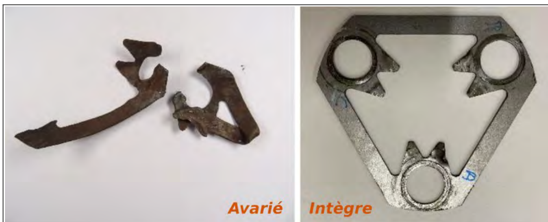
Figure 29 - tôle frein-de-vis (côté avarié et face externe côté intègre) (dossier judiciaire)
