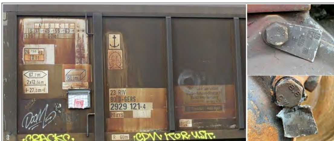
Figure 7 - inscriptions sur le wagon et sur l'essieu endommagé (photo BEA-TT)
