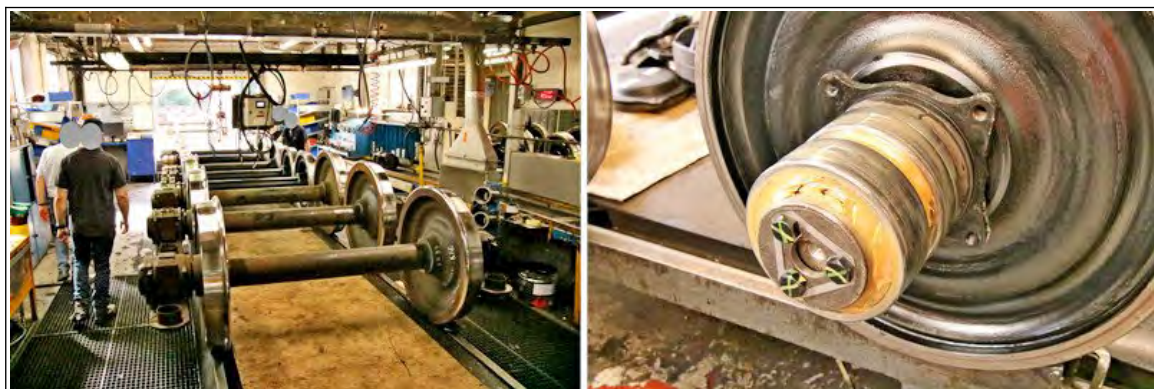
Figure 43 - poste de remontage des roulements (photo BEA-TT)
