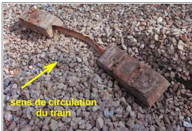
Figure 34 - traverse bi-bloc extraite de la voie ( dossier judiciaire )
