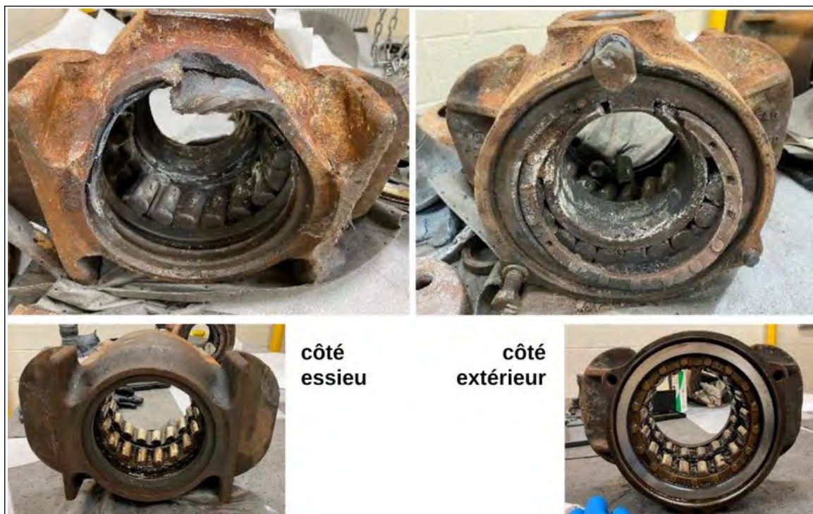
Figure 27 - intérieur en haut, de la boîte tombée et, en bas, de la boîte intègre (côté essieu à gauche, et côté extérieur à droite) (dossier judiciaire)
