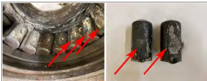
Figure 27 - intérieur en haut, de la boîte tombée et, en bas, de la boîte intègre (côté essieu à gauche, et côté extérieur à droite) (dossier judiciaire)
