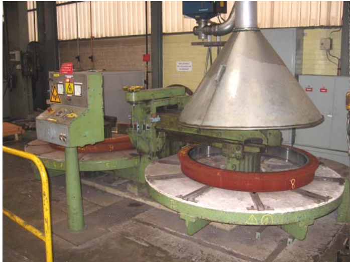
chauffage des bandages par induction (240°)
