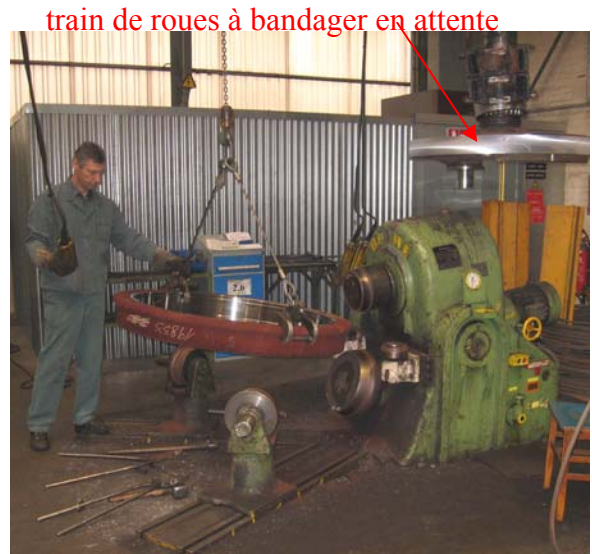
placement du bandage sur la presse à bandager
