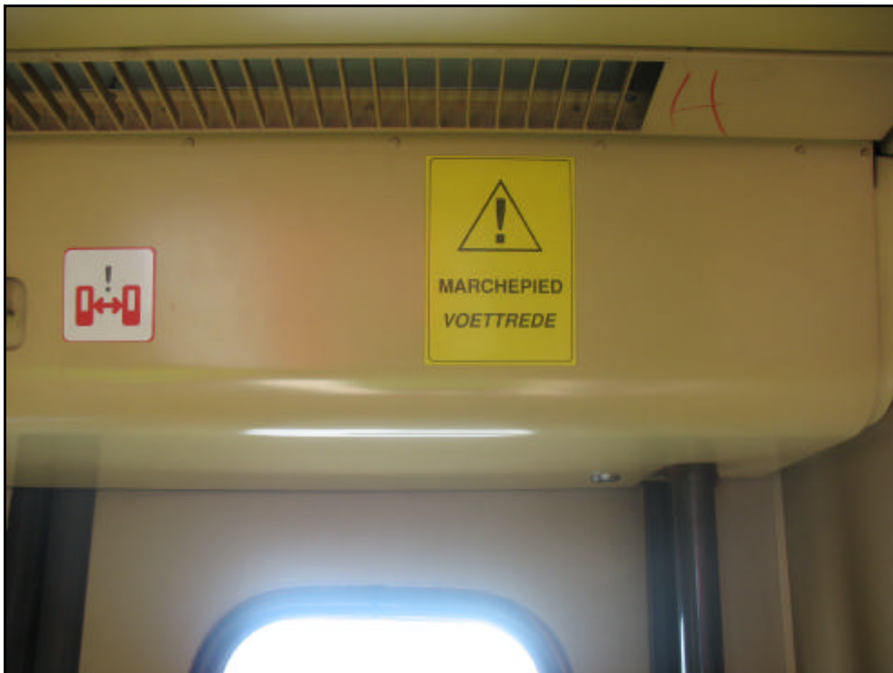
Figuur 27 : Bovenpaneel met noodopeningshendel en pictogrammen, deur nr. 4 MS 399.
