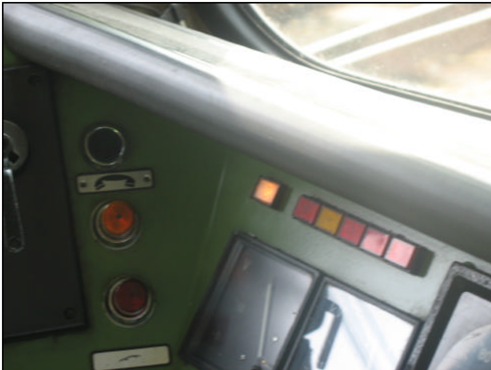
Figuur 28 : Gesloten en vergrendelde deur nr. 4 en brandende witte lamp stuurpost, MS 399.
