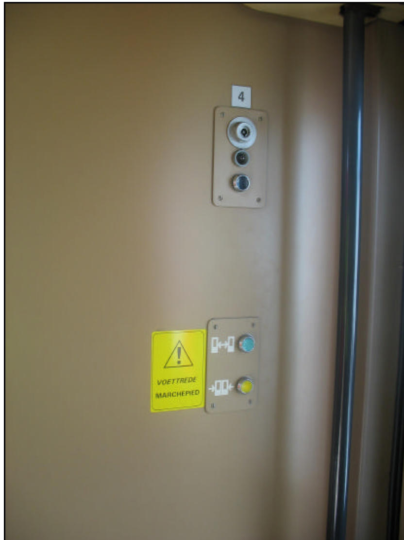
Figuur 26 : Bedieningspaneel (normale bediening) voor reizigers en begeleidingspersoneel, deur nr. 4 MS 399.
