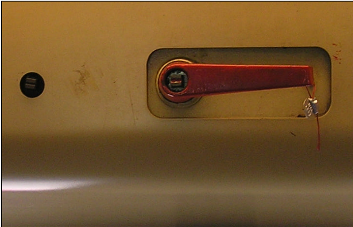
Figuur 30 : Hendel noodopening in neutrale stand met verloding.
