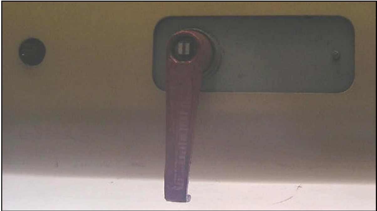
Figuur 31 : Hendel noodopening in bediende stand zonder verloding.
