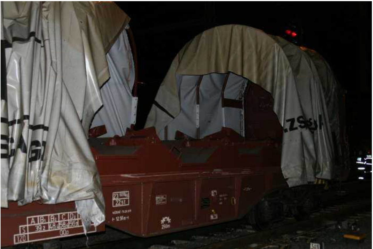
Obr. č. 9: Poškozené 1. TDV posunového dílu
