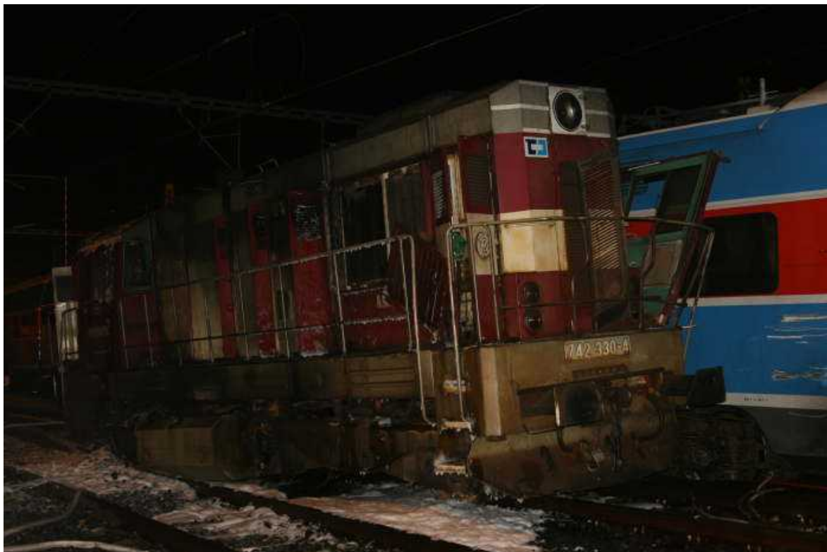
Obr. č. 5: Zdeformované stanoviště vlaku Os 9326
