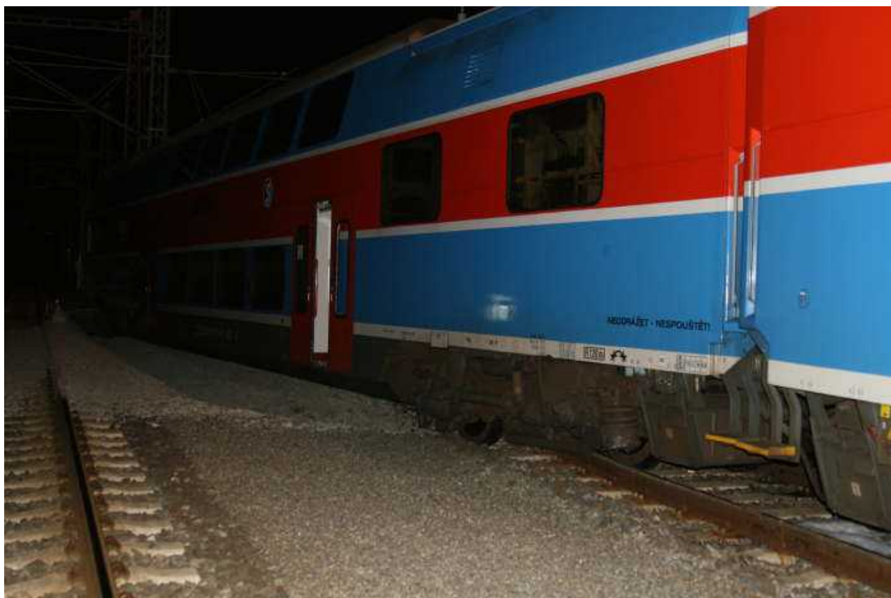
Obr. č. 7: Vykolejené HDV vlaku Os 9326
