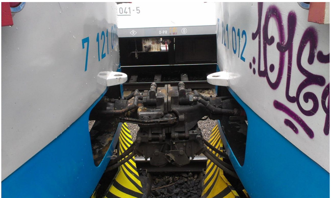
Slika 9. Kvačila na DMG serije 7121 (Izvor AIN).
