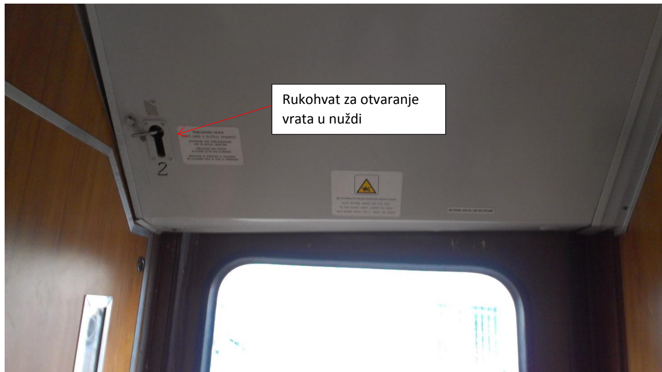
Slika 5 Rukohvat za otvaranje vrata u slučaju nužde (Izvor AIN)
