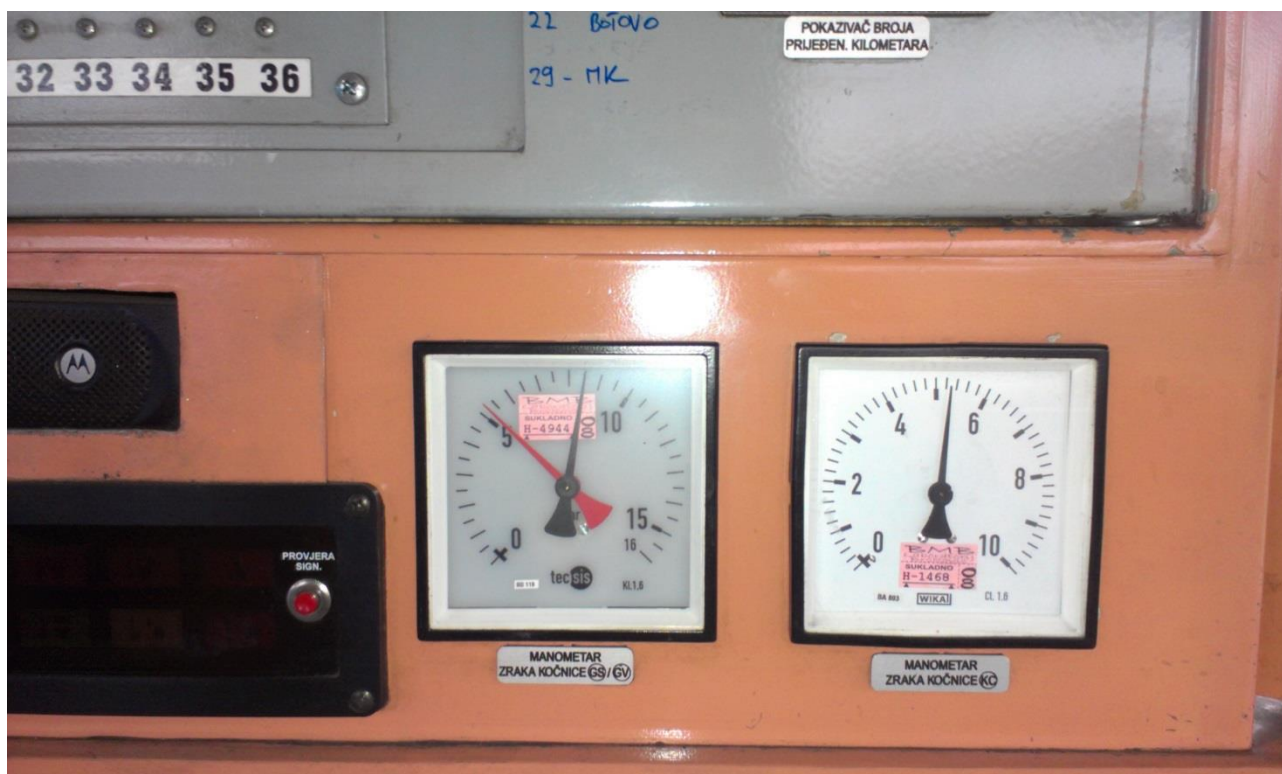
Slika 7 Pokazivači tlaka zračne kočnice lokomotive (Izvor AIN).
