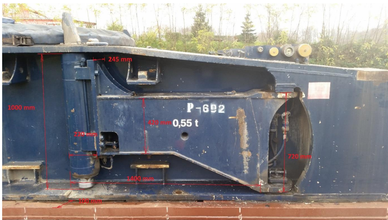
Slika 4 Ruka zadnjeg lijevog stabilizatora dizalice (Izvor AIN).
