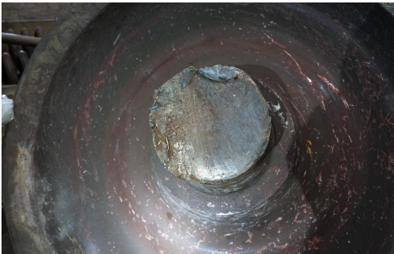
Slika 8. Presjek loma osovine broj 3519 (izvor slike: AIN)
