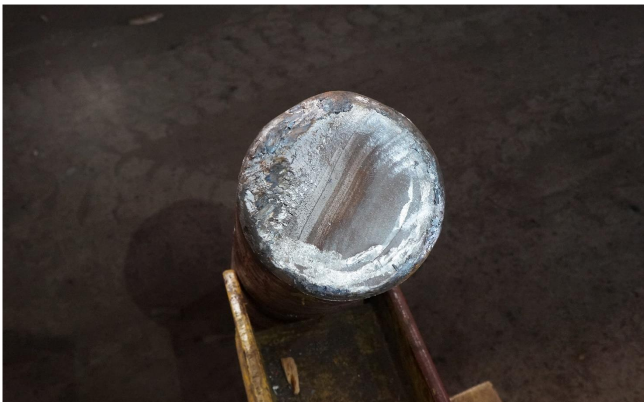
Slika 9. Presjek loma osovine broj 3519 (izvor slike: AIN)
