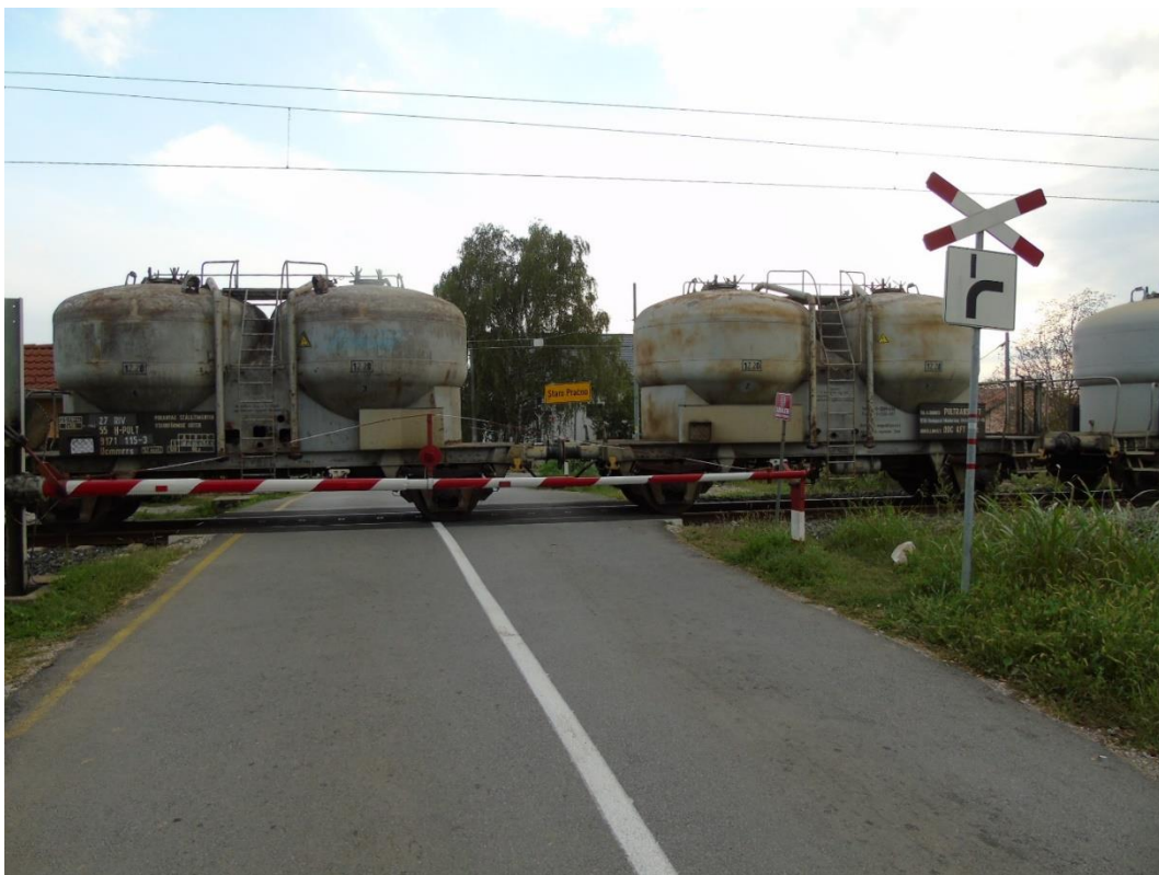
Slika 7. – Prikaz ispravnog rada branika na ŽCP-u „Pračno“ (izvor slike: AIN)
