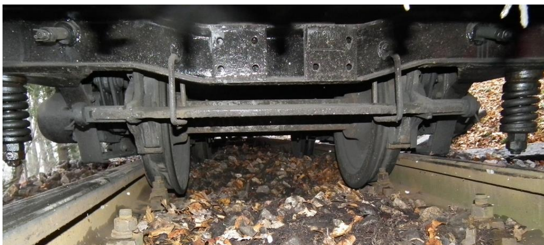
4. ábra: a személykocsi kisiklott forgóváza
