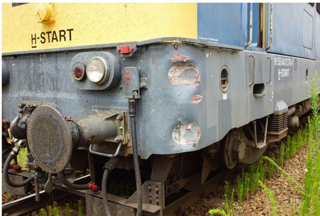
3. ábra: a mozdony sérülése
