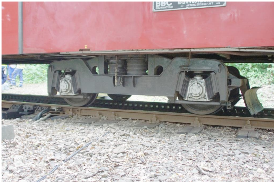
9. ábra: a vezérlőkocsi felső forgóvázának megállási helye
