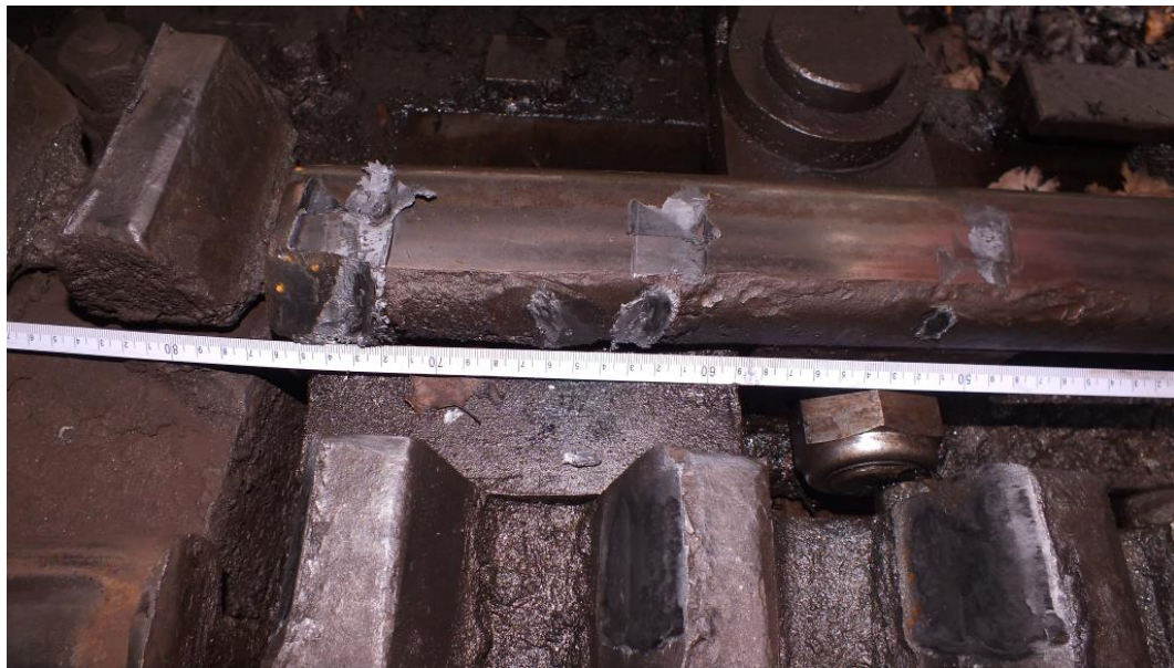
4. ábra: a kapaszkodó fogaskerekek nyoma a sínen
