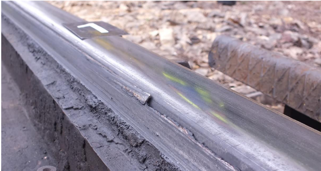
5. ábra: a csúcssín töredezett éle
