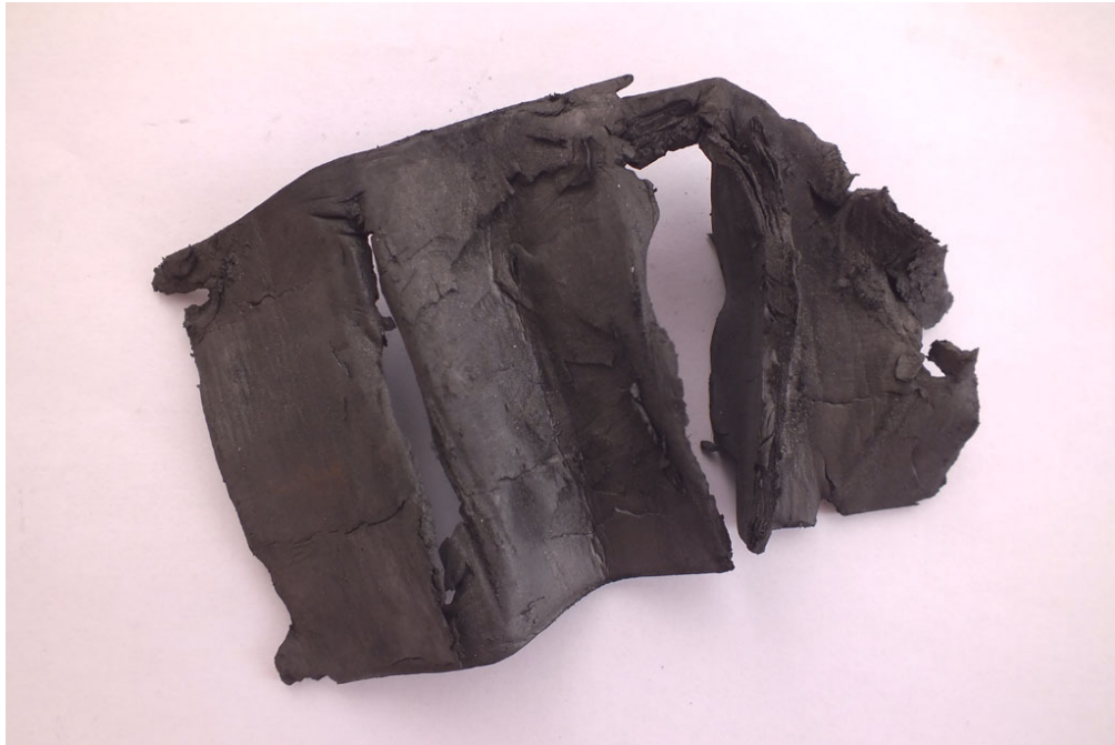
13. ábra: az „A” kerékben a gumirugók között talált szalagdarab
