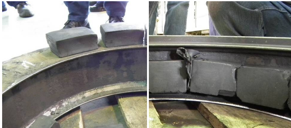
20. ábra: „A” kerék (a balesetben szétesett)
