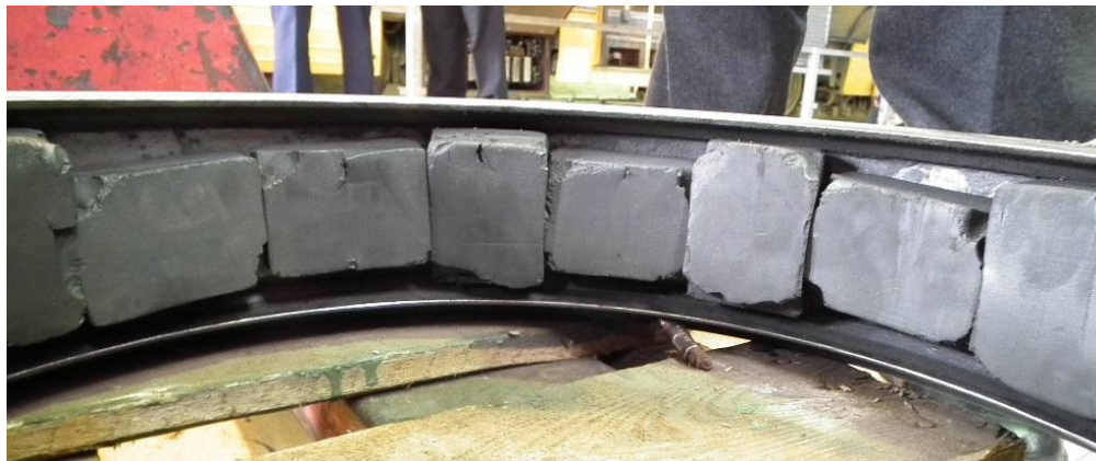
9. ábra: gumielemelek a kerékabroncsban
