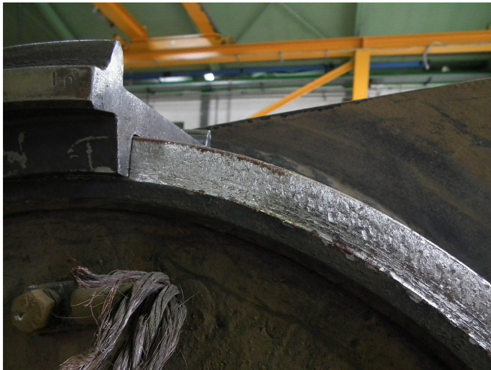
15. ábra: kopásnyom a kerékváz oldalán
