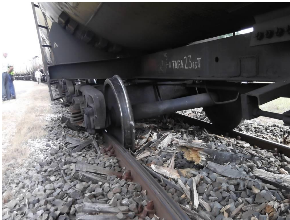
5. ábra: az elhasználódott faaljak a siklás helyén
